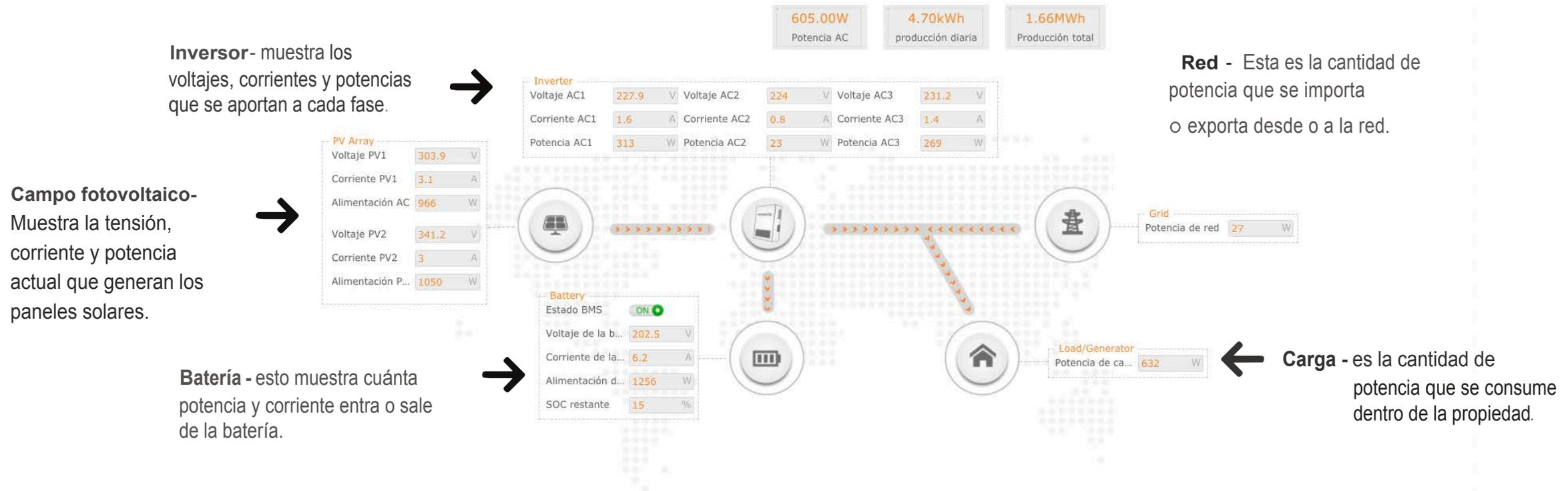
\*La direccionalidad de las flecha en movimiento, en todos los casos, es indicador del funcionamiento de la instalación, observe si hay anomalías.
