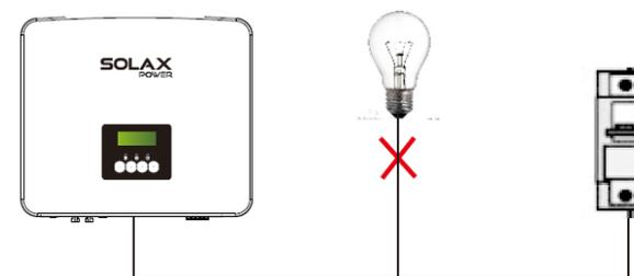
Figura: Conexión incorrecta de suministro e inversor
