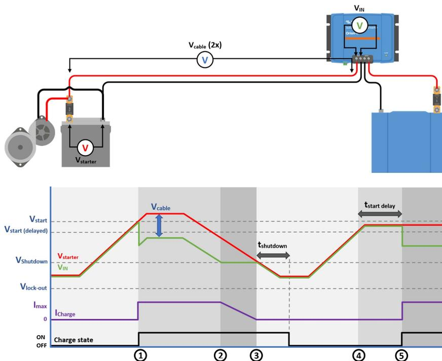
Figura 8: Secuencia de detección de apagado del motor
