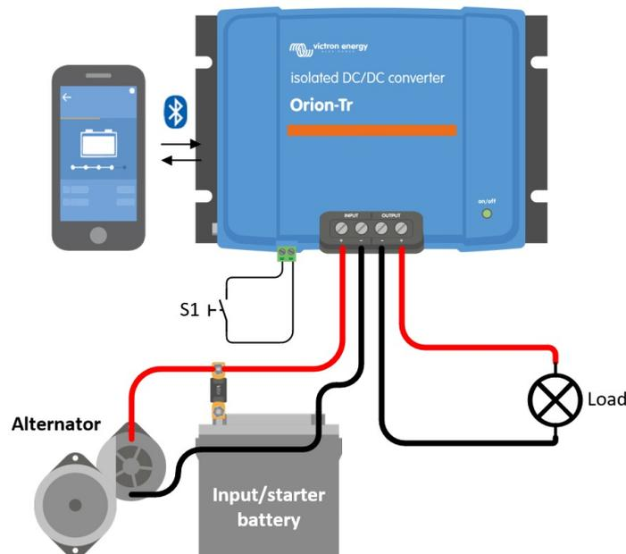
Figura 1: Configuración de conexión normal como convertidor CC-CC
