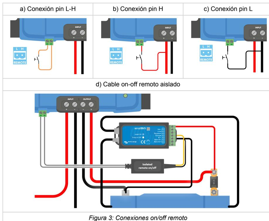
Figura 3: Conexiones on/off remoto
