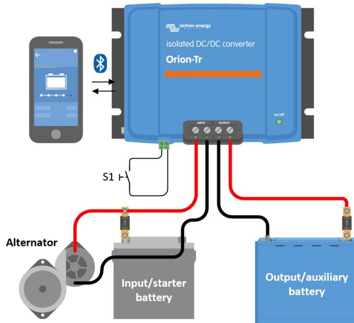
Figura 2: Configuración de conexión normal como cargador
