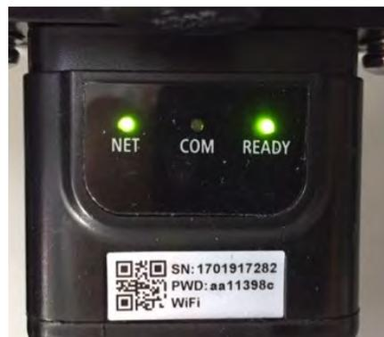
Figura 72 - Estado de comunicación irregular entre inversor y adaptador
