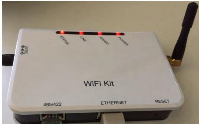
Figura 95 - LED que indica que el datalogger está correctamente configurado
