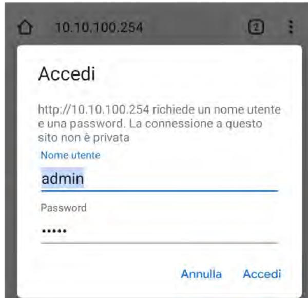
Figura 43 – Pantalla de acceso al servidor Web para configurar el adaptador Wi-Fi
