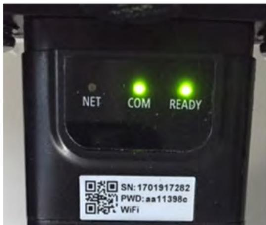
Figura 67 - Estado de comunicación irregular entre el adaptador y el servidor remoto
