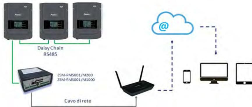
Figura 75 - Esquema que muestra el funcionamiento de los datalogger ZSM-RMS001/M200 / ZSM-RMS001/M1000
