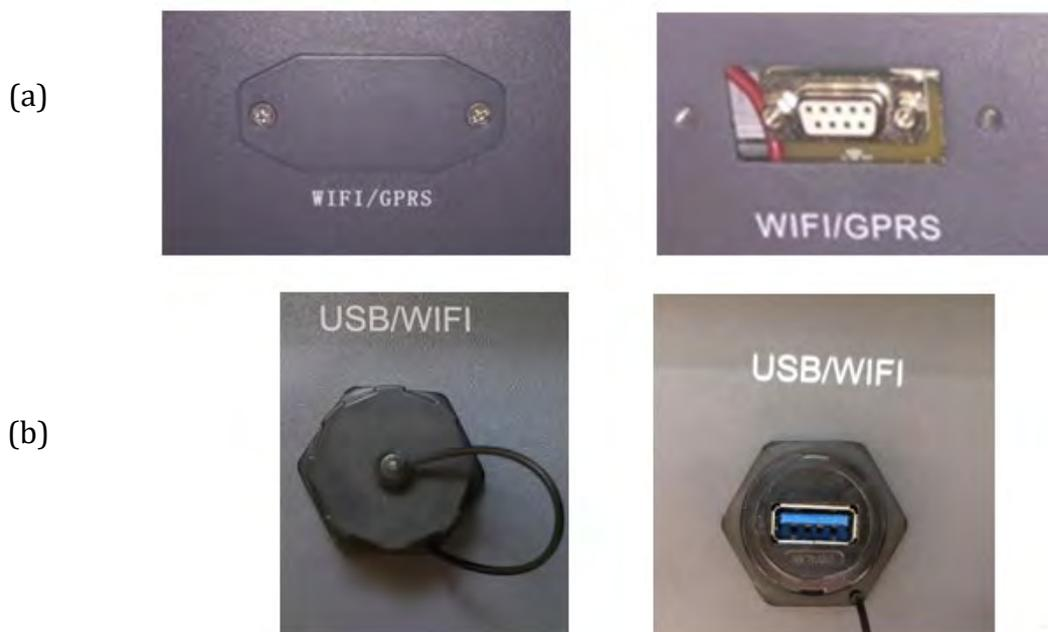
Figura 35 – Puerto para adaptador Wi-Fi externo
