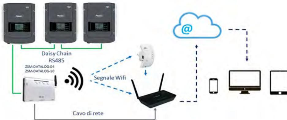
Figura 74 - Esquema para la conexión de los datalogger ZSM-DATALOG-04/ZSM-DATALOG-10
