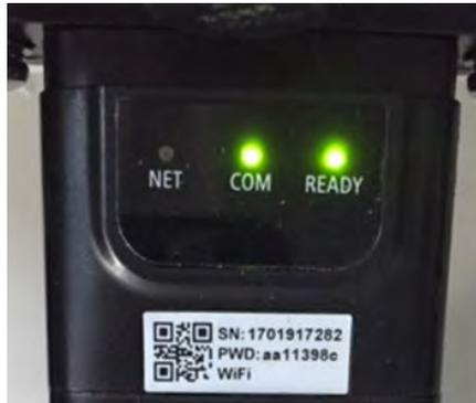
**Figura 73 - Estado de comunicación irregular entre el adaptador y el servidor remoto**
