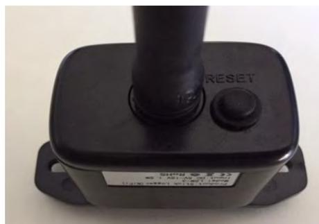
Figura 54 – Botón de Reset en el adaptador Wi-Fi
