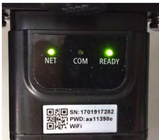
Figura 66 - Estado de comunicación irregular entre el inversor y el adaptador
