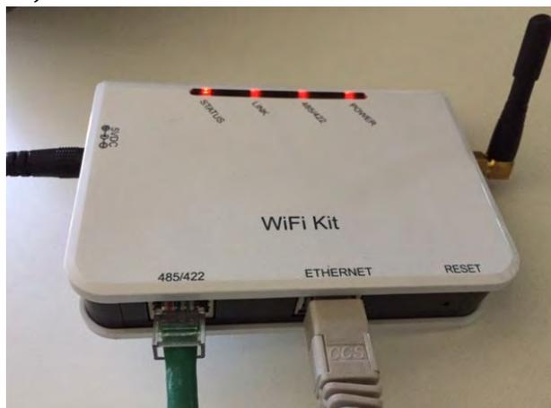
Figura 82- Cable Ethernet conectado al datalogger
