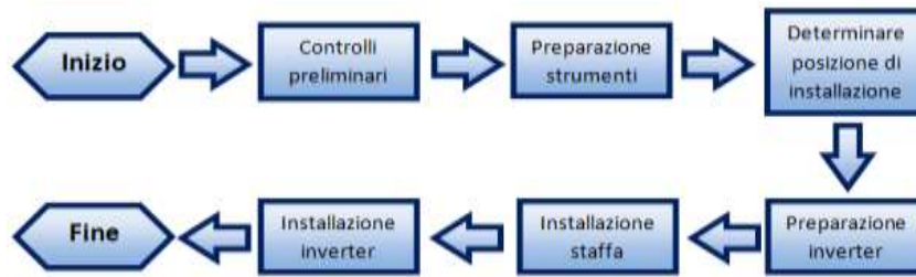
Figura 7 – Pasos de instalación
