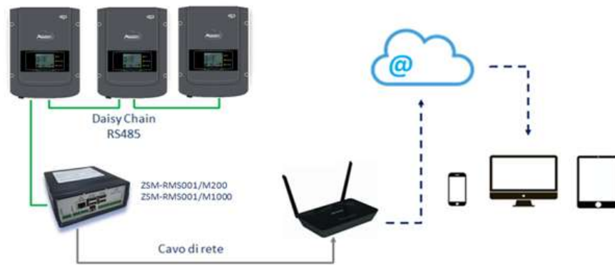
Figura 75 – Esquema de funcionamiento del Datalogger ZSM-RMS001/M200 / ZSM-RMS001/M1000
