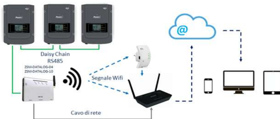
Figura 74 - Esquema de conexión del datalogger ZSM-DATALOG-04 / ZSM-DATALOG-10
