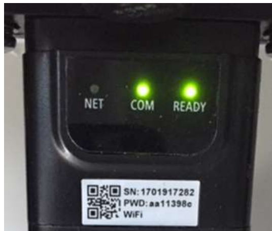
Figura 67 – Estado de comunicación irregular entre tarjeta y servidor remoto
