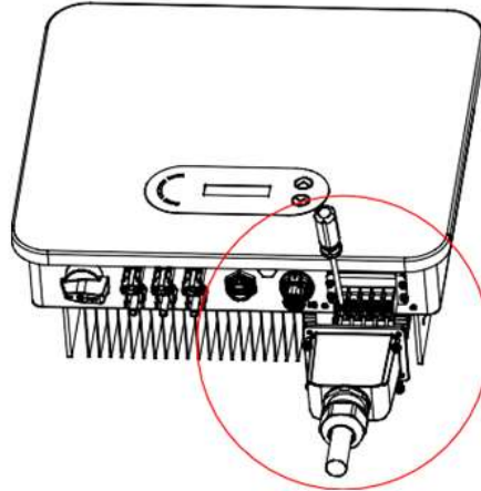
Figura 24 - Conexión de los cables CA de salida (3)
