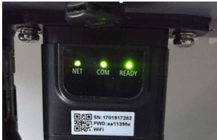
Figura 65 - Estado final de los led
