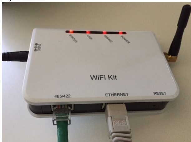
Figura 88– Cable Ethernet conectado al datalogger
