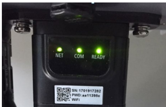
Figura 77 - Estado final de los LED
