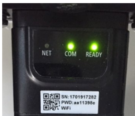
Figura 79- Estado de comunicación irregular entre adaptador y servidor remoto
