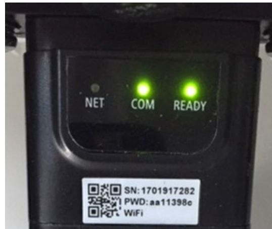
Figura 73- Estado de comunicación irregular entre adaptador y servidor remoto
