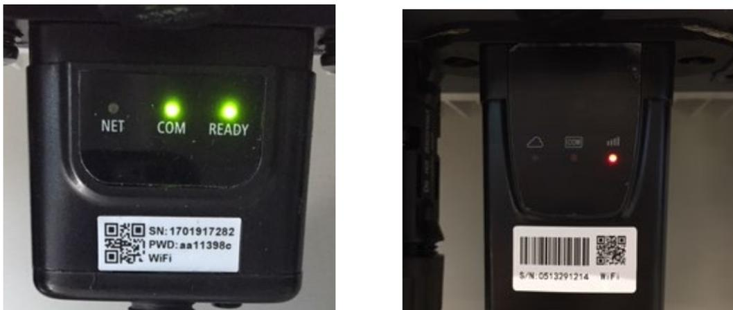
Figura 64- Estado de comunicación irregular entre Wi-Fi y servidor remoto
