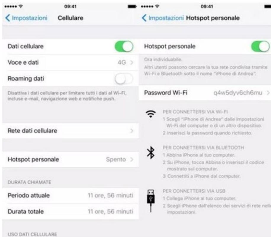
Figura 66- Configuración de un smartphone iOS como router hotspot
