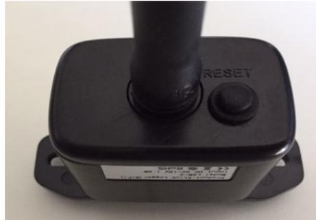
Figura 61 – Botón de Reset en el adaptador Wi-Fi
