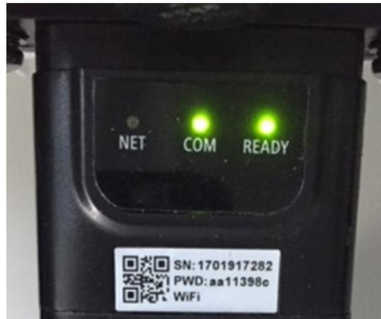
Figura 74 - Estado de comunicación irregular entre el adaptador y el servidor remoto
