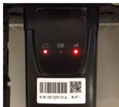
Figura 62 - Estado de comunicación irregular entre inversor y Wi-Fi
