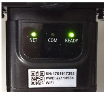
Figura 79 - Estado de comunicación irregular entre inversor y adaptador
