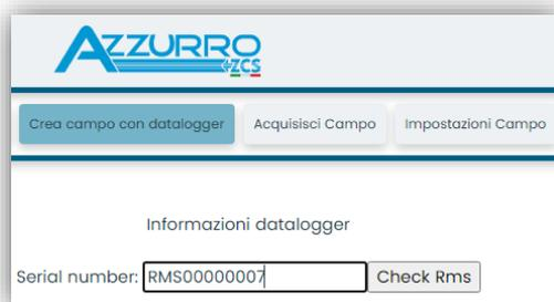
Introduzca el número de serie (S/N) del datalogger y haga clic en “Check RMS” (Verifique RMS). Si el datalogger está correctamente configurado, se abrirá una página donde se puede introducir la información solicitada en relación con el campo a instalar.
