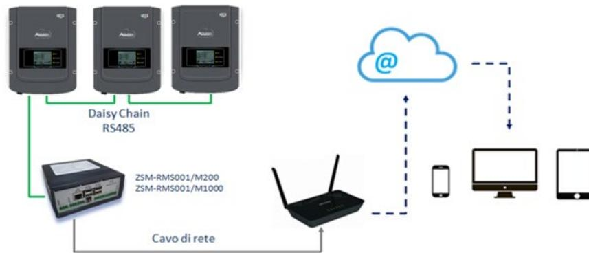
Figura 82 – Esquema que muestra el funcionamiento de los datalogger ZSM-RMS001/M200 / ZSM-RMS001/M1000
