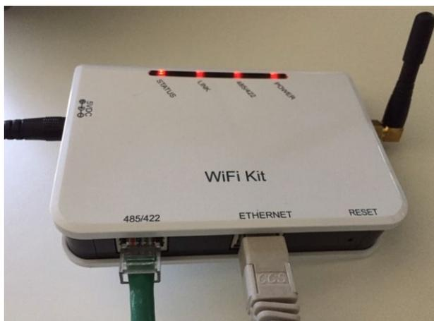
Figura 89- Cable Ethernet conectado al datalogger
