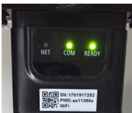
Figura 80 - Estado de comunicación irregular entre el adaptador y el servidor remoto
