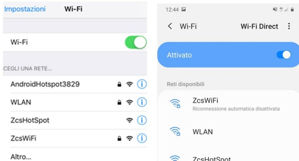
Figura 57 – Búsqueda de la red Wi-Fi en el smartphone (iOS y Android); el punto de acceso del adaptador Wi-Fi ha dejado de estar visible.
