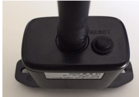
Figura 56 – Botón de Reset en el adaptador Wi-Fi
