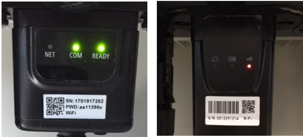
Figura 59- Estado de comunicación irregular entre Wi-Fi y servidor remoto
