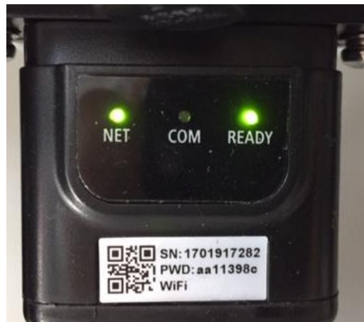
Figura 68 - Estado de comunicación irregular entre inversor y adaptador
