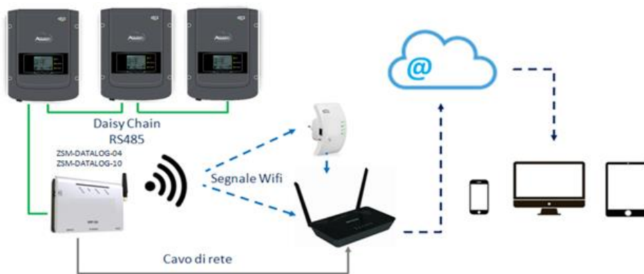
Figura 76 – Esquema de conexión del datalogger ZSM-DATALOG-04/ZSM-DATALOG-10
