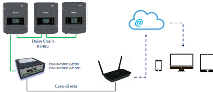
Figura 77 – Esquema que muestra el funcionamiento del datalogger ZSM-RMS001/M200 / ZSM-RMS001/M1000
