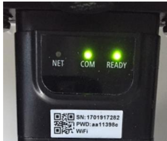
Figura 69- Estado de comunicación irregular entre adaptador y servidor remoto
