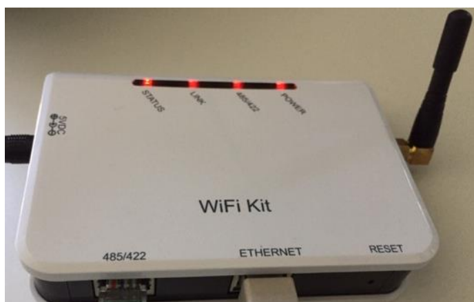
Figura 98 - LED que indica que el datalogger está correctamente configurado
