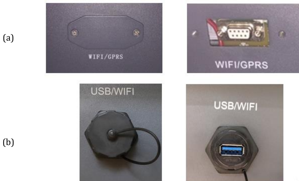
Figura 37 – Puerto para adaptador Wi-Fi externo
