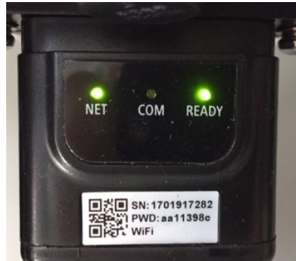
Figura 139 - Estado de comunicación irregular entre inversor y tarjeta
