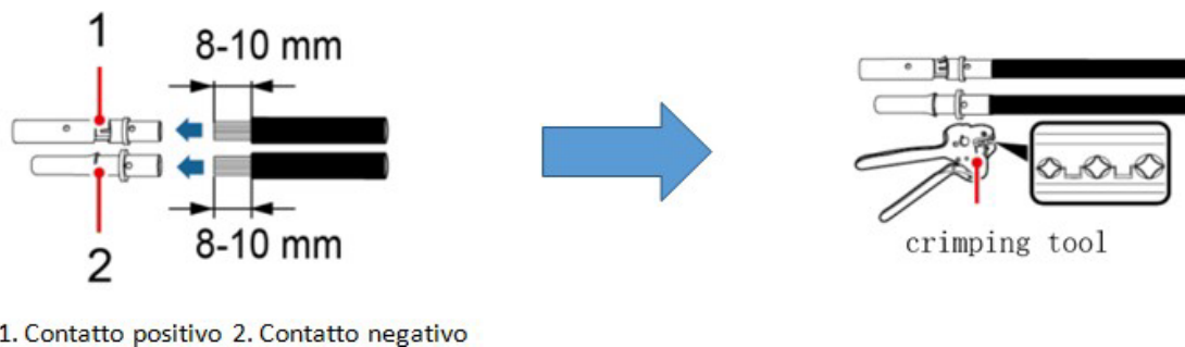
Figura 7 - Preparación de los cables fotovoltaicos positivo y negativo
