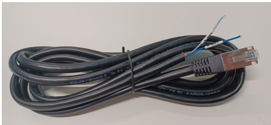
Figura 64 - Cable de comunicación entre el inversor y la batería AZZURRO 5000
