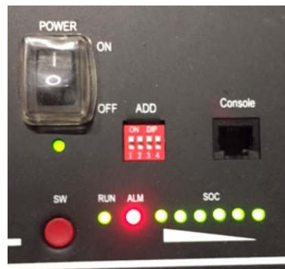
Figura 100 - Estado de la batería después de haber establecido el interruptor POWER en ON y haber pulsado el botón SW
