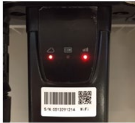
Figura 122 - Estado de comunicación irregular entre inversor y wifi
