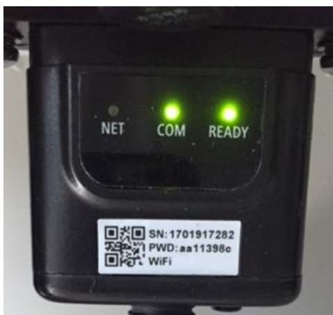
Figura 124 – Estado de comunicación irregular entre wifi y servidor remoto
