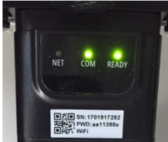
Figura 134 – Estado de comunicación irregular entre tarjeta y servidor remoto
