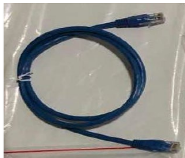
Figura 84 - Cable de comunicación entre baterías AZZURRO ZSX 5120
