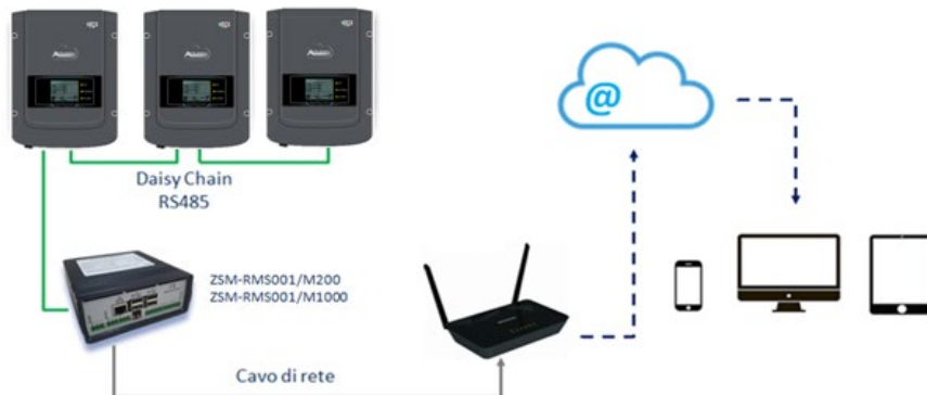
Figura 142 – Esquema de funcionamiento del datalogger ZSM-RMS001/M200 / ZSM-RMS001/M1000
