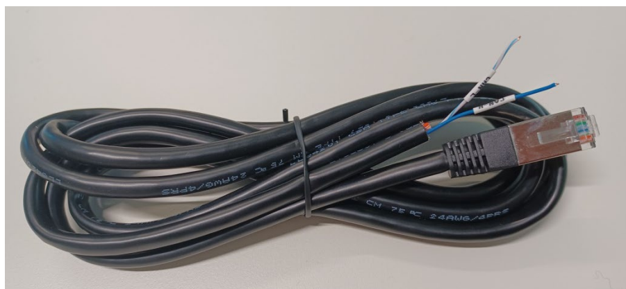
Figura 72 - Cable de comunicación entre el inversor y la batería AZZURRO 5000 PRO
