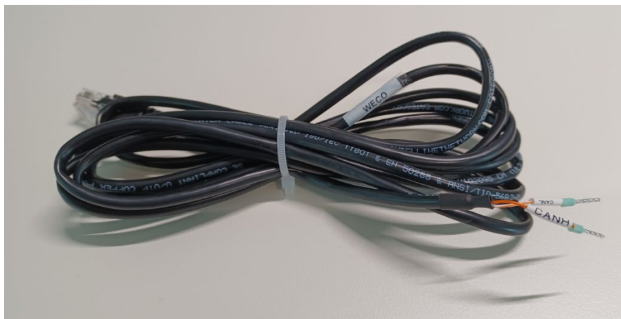
Figura 37 - Cable de comunicación entre el inversor y la batería WeCo 4k4-LT
