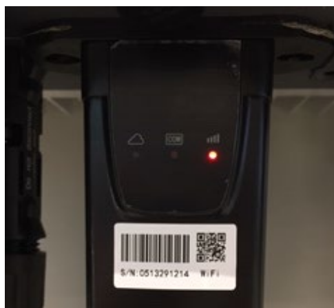
Figura 124 – Estado de comunicación irregular entre wifi y servidor remoto
