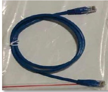
Figura 48 – Cable de comunicación entre baterías WeCo 5k3
