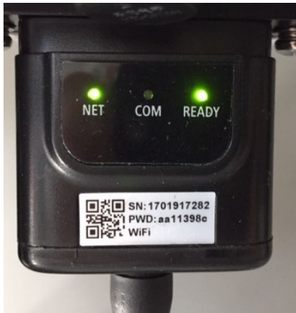
Figura 122 - Estado de comunicación irregular entre inversor y wifi
