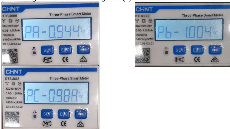
3. Encienda el fotovoltaico del inversor mediante seccionador giratorio en ON y baterías, compruebe que el valor de potencia total Pt esté en línea con el valor mostrado en la pantalla del inversor
