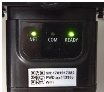
Figura 215 - Estado de comunicación irregular entre inversor y tarjeta
