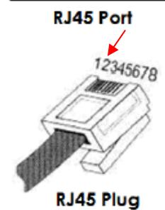
Figura 36 - Pin Out entrada CAN BMS
