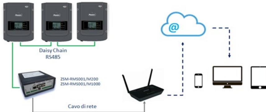
Figura 218 – Esquema de funcionamiento del Datalogger ZSM-RMS001/M200 / ZSM-RMS001/M1000
