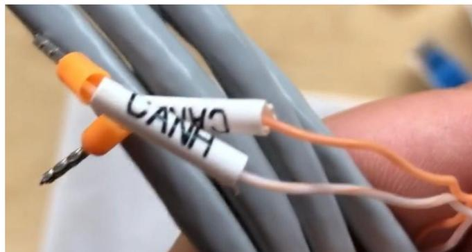
Figura 93 - Cable de comunicación Inversor/HV BOX
