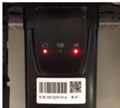
Figura 198 - Estado de comunicación irregular entre inversor y wifi
