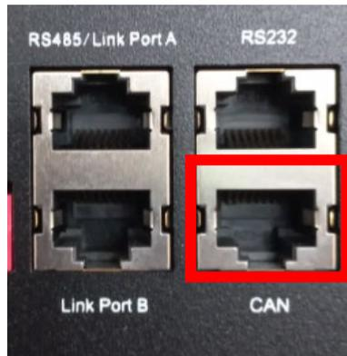
Figura 35 - Entrada CAN del BMS SC500 Wifi/USB y SC1000 Wifi/USB
