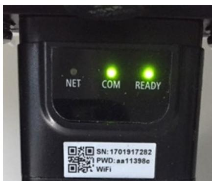
Figura 216 – Estado de comunicación irregular entre tarjeta y servidor remoto
