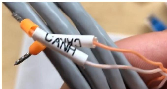
Figura 70 - Cable de comunicación Inversor/HV BOX
