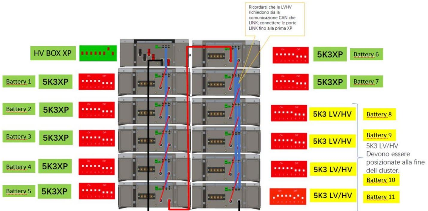
Figura 112 - Conexión de potencia y comunicación de baterías 5K3 y 5K3XP
