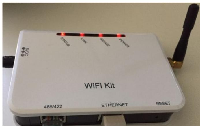
Figura 240 – Led que indican que el datalogger está correctamente configurado
