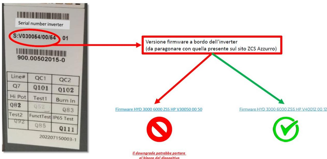
**¡¡ATENCIÓN!! Pasar a una versión inferior del firmware del inversor podría causar la avería del dispositivo.**
