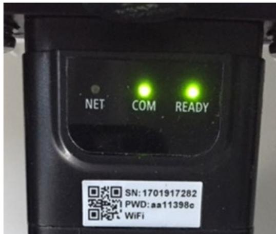
Figura 210 – Estado de comunicación irregular entre tarjeta y servidor remoto
