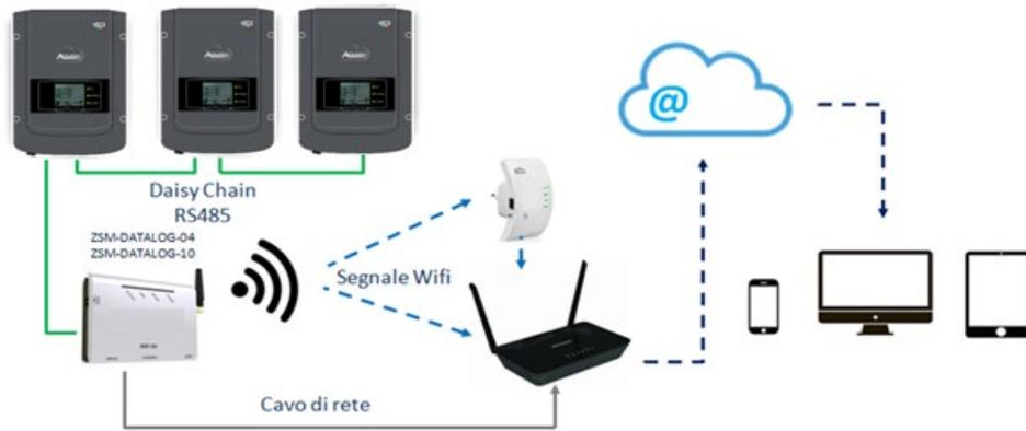
Figura 217 – Esquema de conexión del datalogger ZSM-DATALOG-04 / ZSM-DATALOG-10
