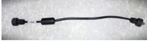
Figura 134 – Cable de comunicación entre BDU1 y BDU2
