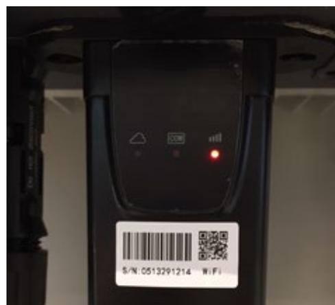
Figura 200 – Estado de comunicación irregular entre wifi y servidor remoto
