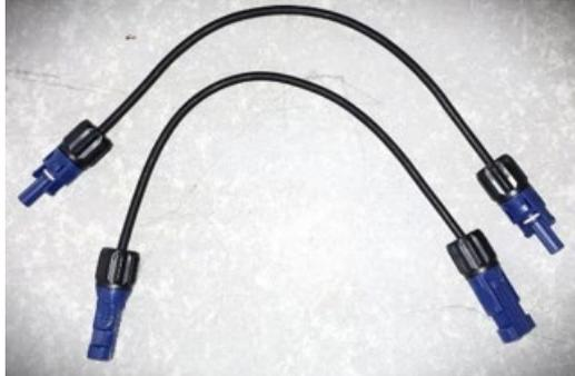
Figura 142 - Conector de potencia entre módulos de batería
