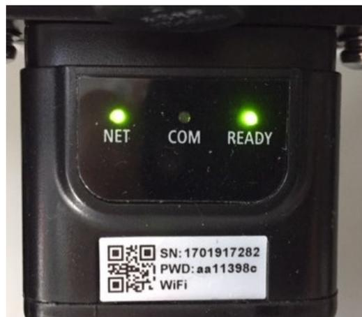
Figura 209 - Estado de comunicación irregular entre inversor y tarjeta
