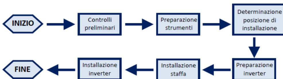
**Figura 3 - Proceso de instalación**
