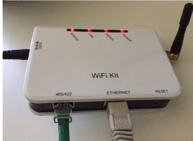
Figura 227 - Cable ethernet conectado al datalogger
