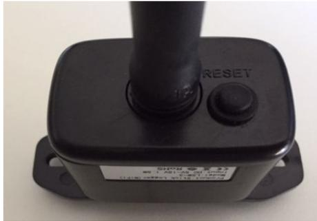
Figura 197 - Tecla de reset en la tarjeta wifi
