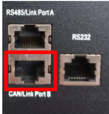
Figura 34 - Entrada CAN del BMS SC500 y SC1000
