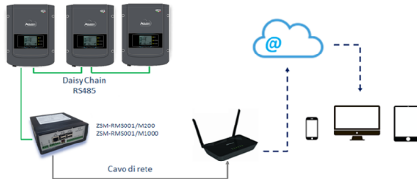
Figura 86 – Esquema de funcionamiento del Datalogger ZSM-RMS001/M200 / ZSM-RMS001/M1000
