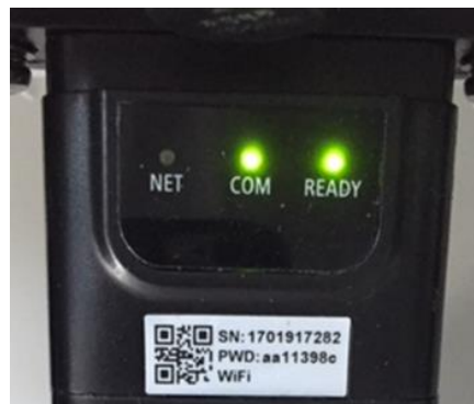
Figura 84 - Estado de comunicación irregular entre tarjeta y servidor remoto
