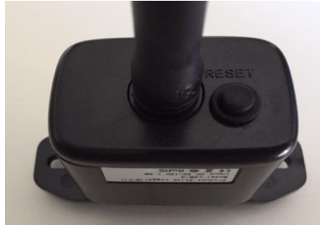
Figura 65 – Tecla de reset en la tarjeta wifi
