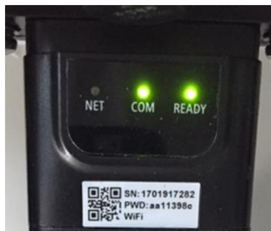
Figura 78 - Estado de comunicación irregular entre tarjeta y servidor remoto
