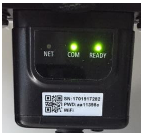
Figura 68 – Estado de comunicación irregular entre wifi y servidor remoto
