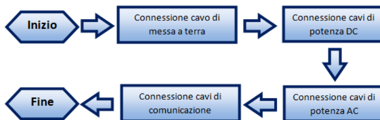
Figura 14 - Pasos para la conexión de los cables
