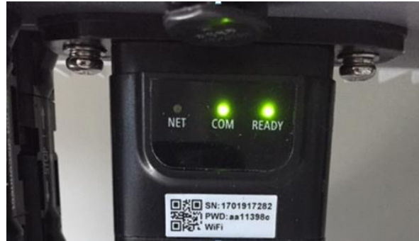
Figura 81 - Estado inicial de los led
