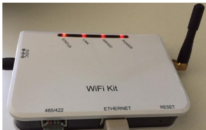
Figura 106 – Led que indican que el datalogger está correctamente configurado
