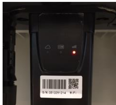
Figura 68 – Estado de comunicación irregular entre wifi y servidor remoto
