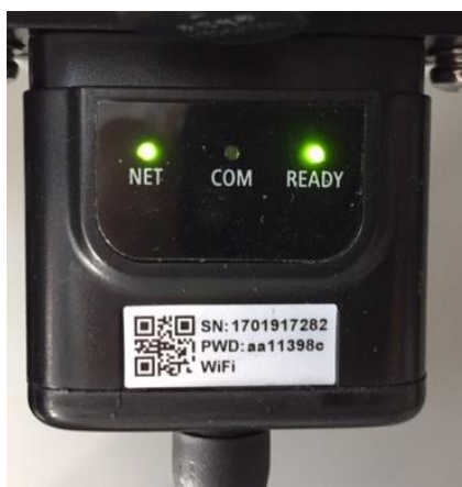
Figura 66 - Estado de comunicación irregular entre inversor y wifi
