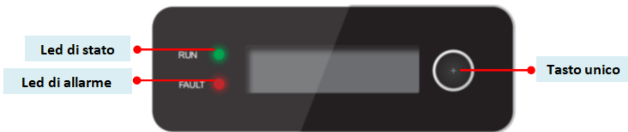
Figura 43 – Pantalla LCD con botones e indicadores led
