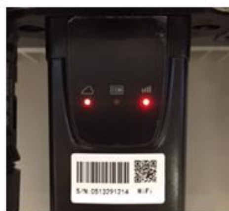
Figura 66 - Estado de comunicación irregular entre inversor y wifi
