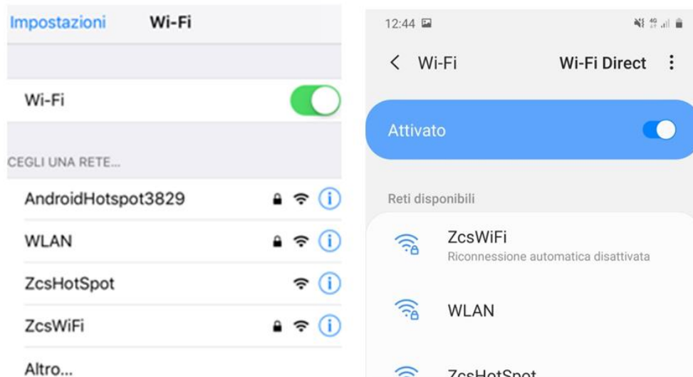
Figura 61 - Búsqueda de las redes wifi en Smartphone (iOS y Android); el Punto de Acceso de la tarjeta wifi ha dejado de estar visible.
