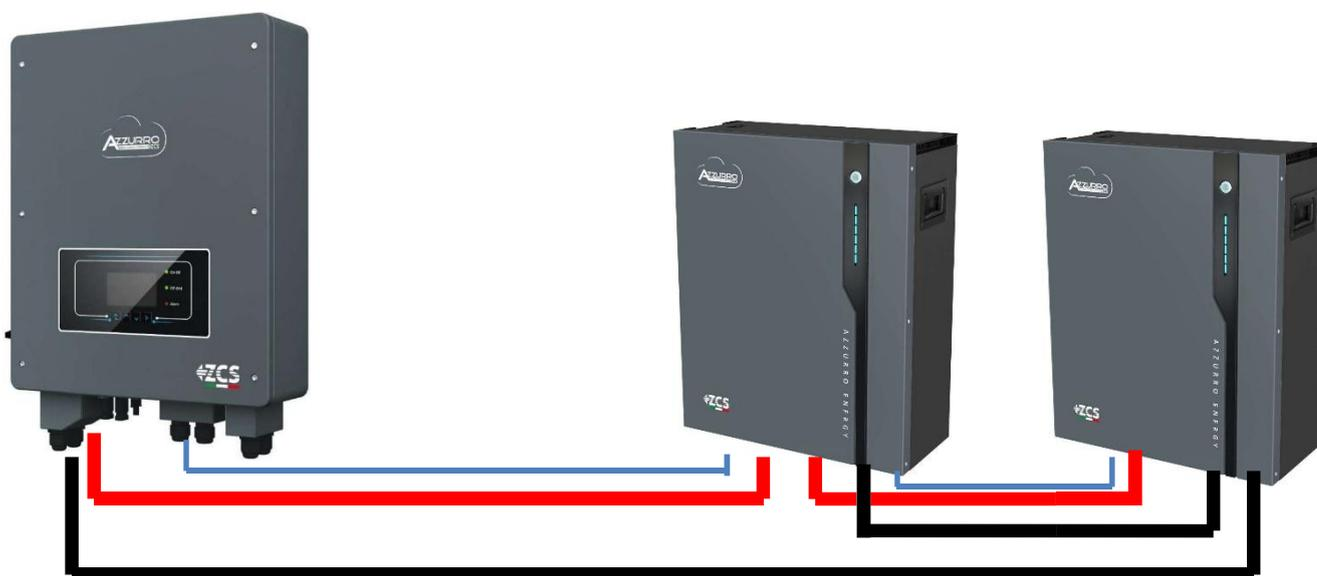
Figura 3 - ejemplo de conexiones con 2 baterías
