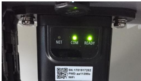
Figura 70 - Estado inicial de los led
