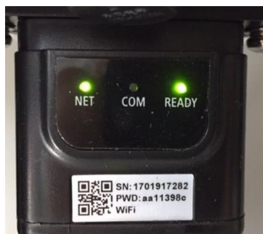
Figura 66 - Estado de comunicación irregular entre inversor y tarjeta
