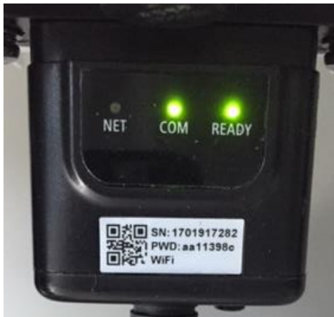
Figura 57 – Estado de comunicación irregular entre wifi y servidor remoto
