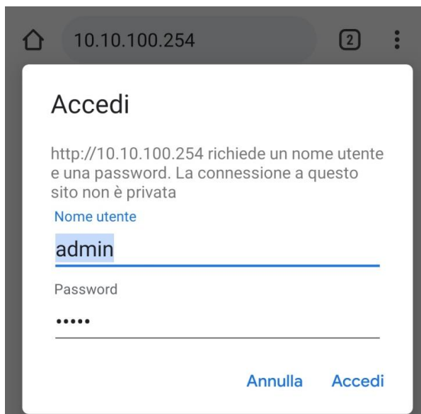
Figura 43 – Pantalla de acceso al servidor web para la configuración la tarjeta wifi
