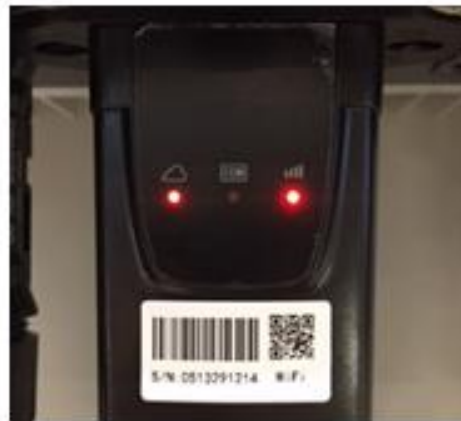
Figura 55 - Estado de comunicación irregular entre inversor y wifi
