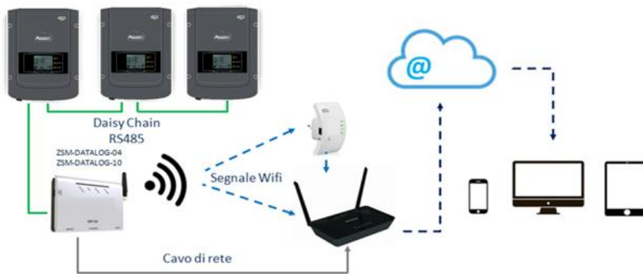
Figura 74 - Esquema de conexión del datalogger ZSM-DATALOG-04 / ZSM-DATALOG-10
