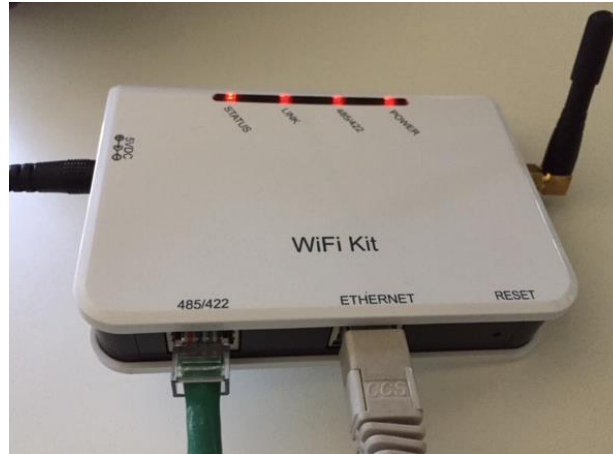
Figura 82 - Cable ethernet conectado al datalogger
