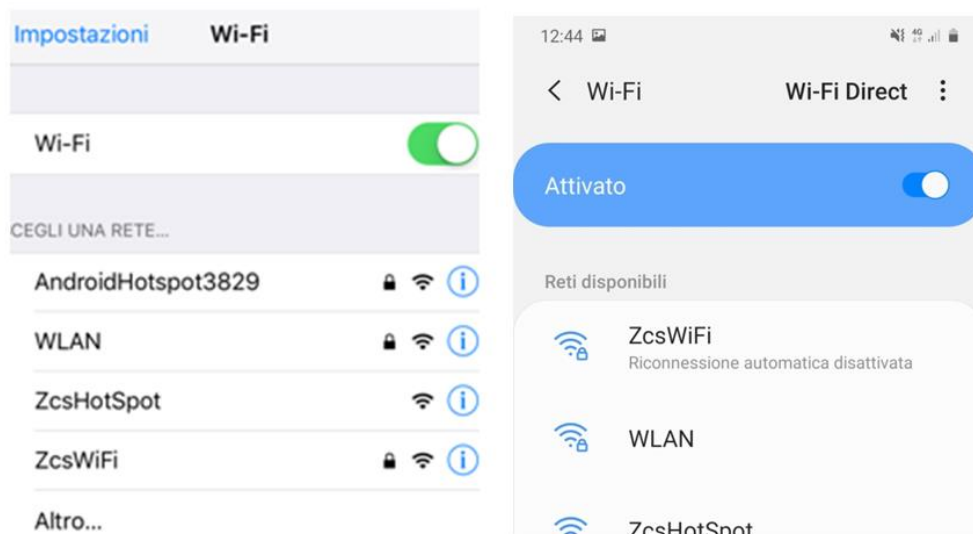
Figura 50 - Búsqueda de las redes wifi en Smartphone (iOs y Android); el Punto de Acceso de la tarjeta wifi ha dejado de estar visible.
