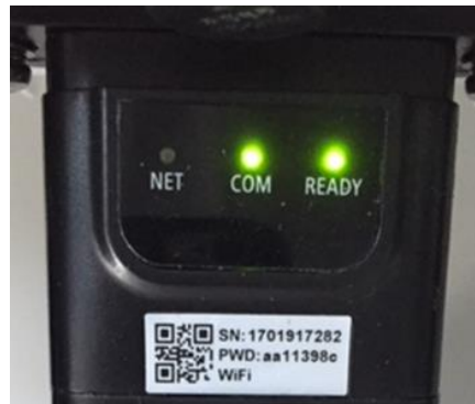
Figura 73 – Estado de comunicación irregular entre tarjeta y servidor remoto
