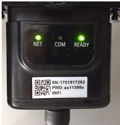
Figura 55 - Estado de comunicación irregular entre inversor y wifi
