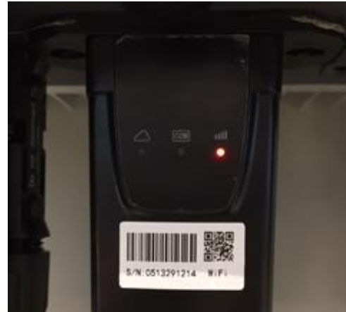
Figura 57 – Estado de comunicación irregular entre wifi y servidor remoto
