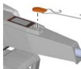
Fig. 55: Llave magnética de parada de emergencia
