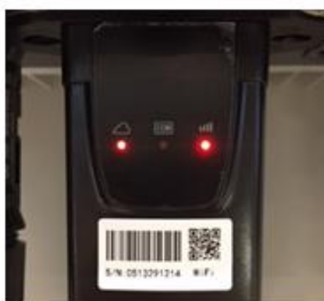
Figura 108 - Estado de comunicación irregular entre inversor y wifi
