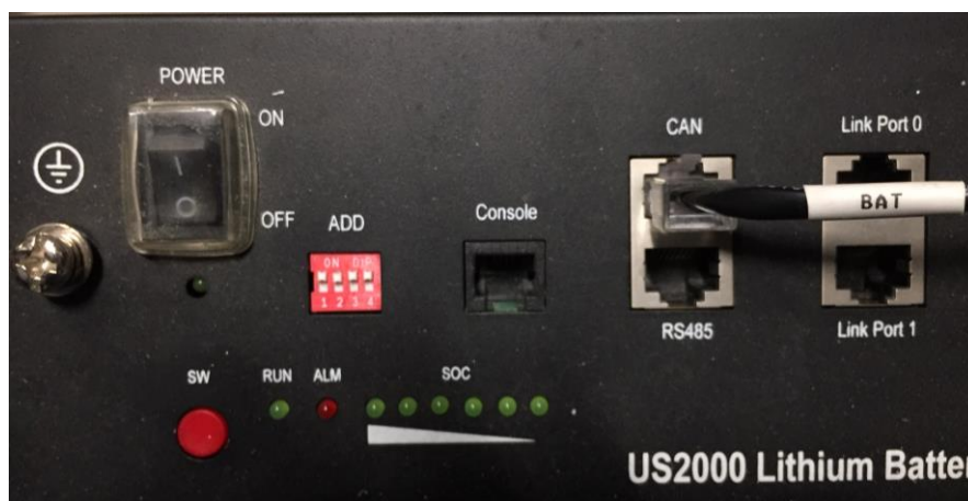
Figura 12 - Conexión del cable de comunicación en la batería Pylontech
