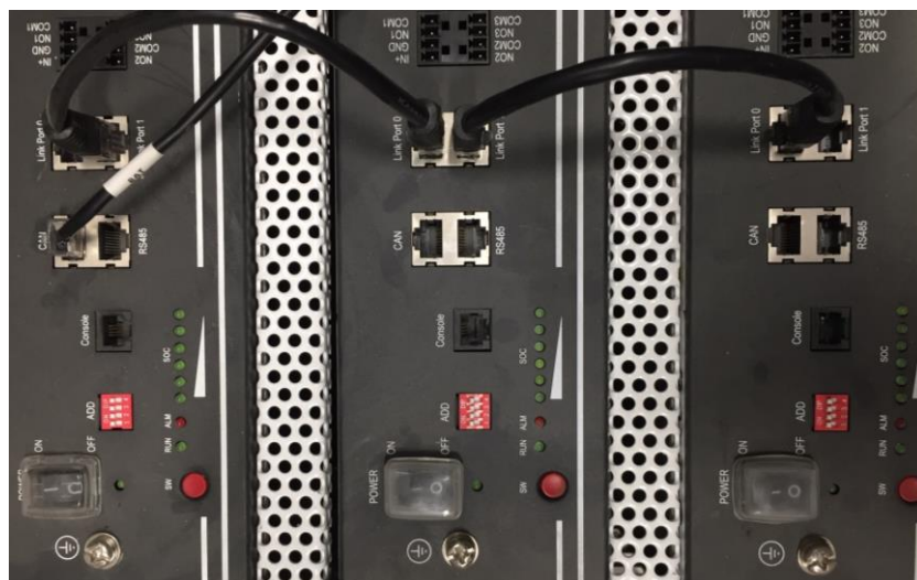
Figura 14 - Conexión de comunicación entre tres baterías Pylontech
