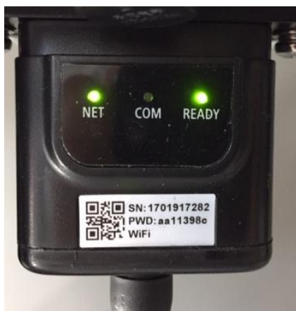
Figura 108 - Estado de comunicación irregular entre inversor y wifi
