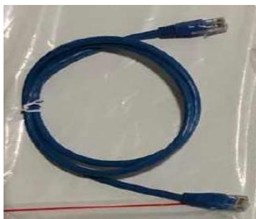
Figura 50- Cable de comunicación entre baterías AZZURRO 5000
