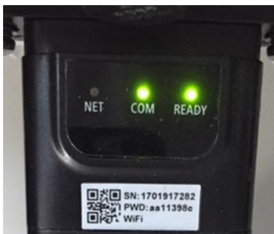
Figura 120 – Estado de comunicación irregular entre tarjeta y servidor remoto
