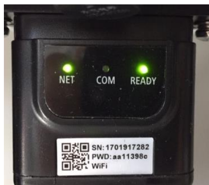
Figura 125 - Estado de comunicación irregular entre inversor y tarjeta
