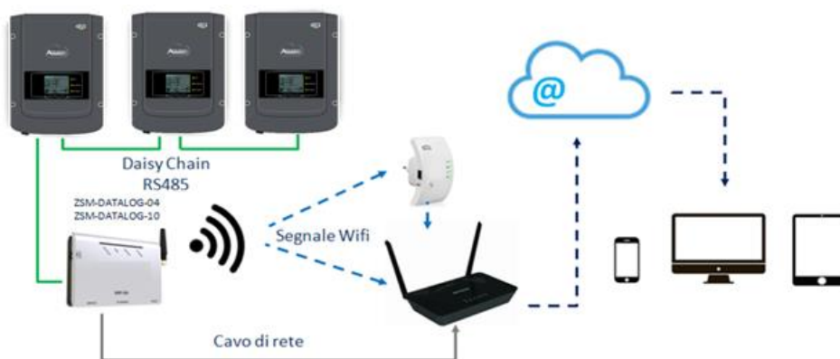
Figura 127 – Esquema de conexión del datalogger ZSM-DATALOG-04 / ZSM-DATALOG-10
