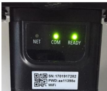
Figura 126 – Estado de comunicación irregular entre tarjeta y servidor remoto
