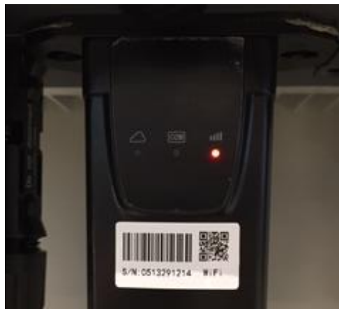
Figura 110 – Estado de comunicación irregular entre wifi y servidor remoto
