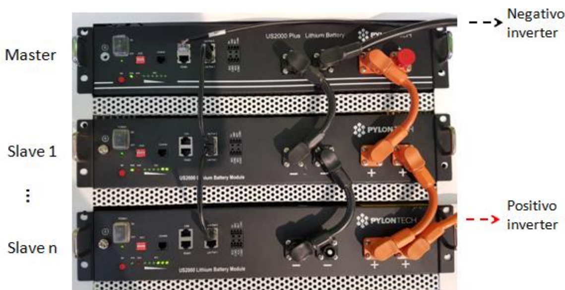
Figura 13 - Tres baterías Pylontech en paralelo
