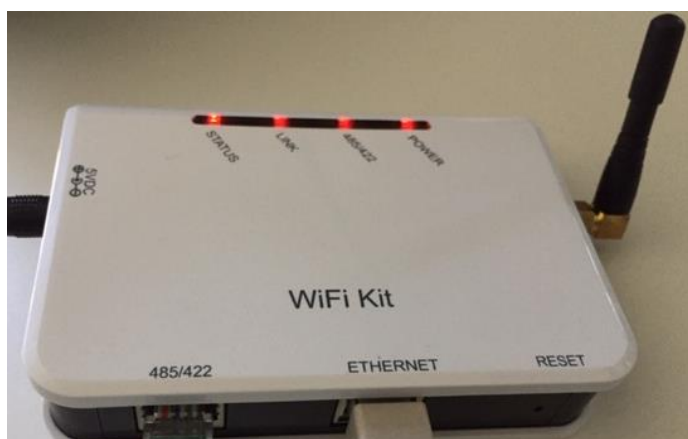
Figura 149 – Led que indican que el datalogger está correctamente configurado
