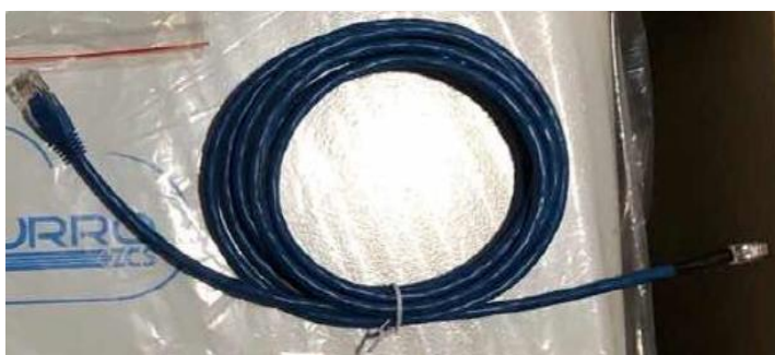
Figura 15 - Cable de comunicación entre inversor y batería WeCo 4k4
