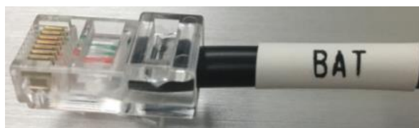
Figura 11 - Cable de comunicación Pylontech, clavija a enchufar en la entrada de comunicación
