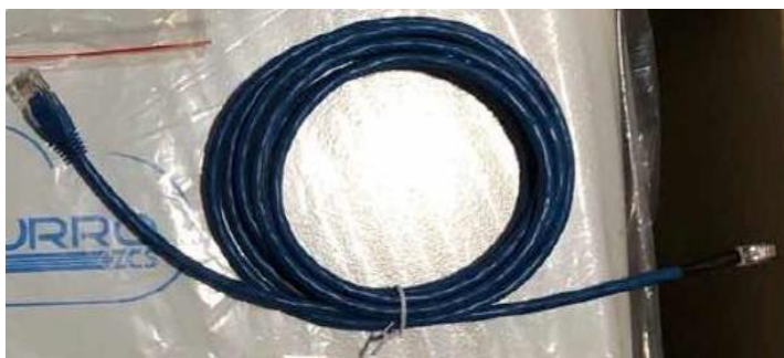
Figura 35 - Cable de comunicación entre inversor y batería WeCo 5K3XP
