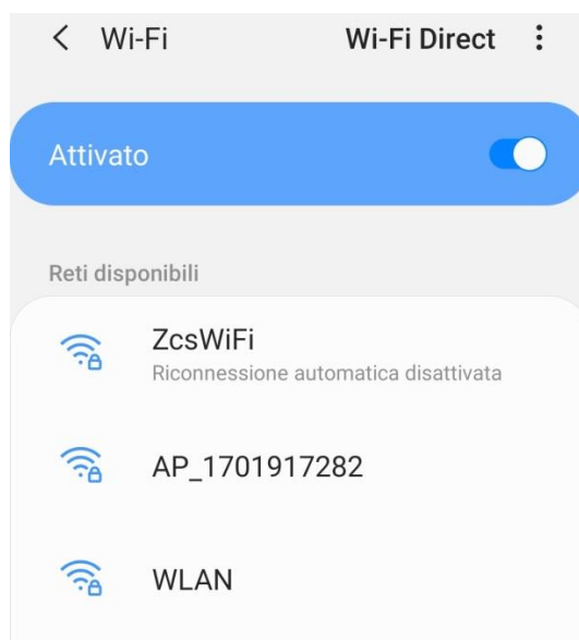
Figura 92 - Desactivación de la reconexión automática a una red
