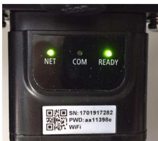
Figura 119 - Estado de comunicación irregular entre inversor y tarjeta
