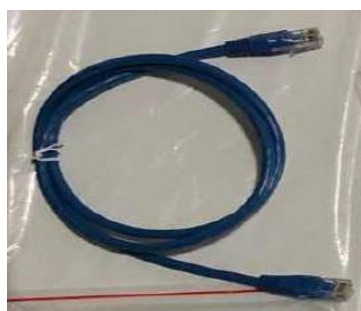
Figura 23 – Cable de comunicación entre baterías WeCo 4k4 PRO
