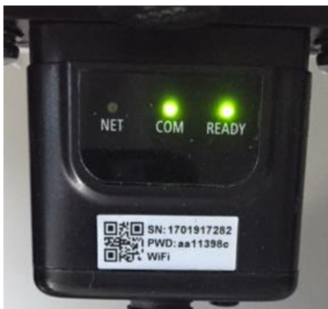
Figura 110 – Estado de comunicación irregular entre wifi y servidor remoto
