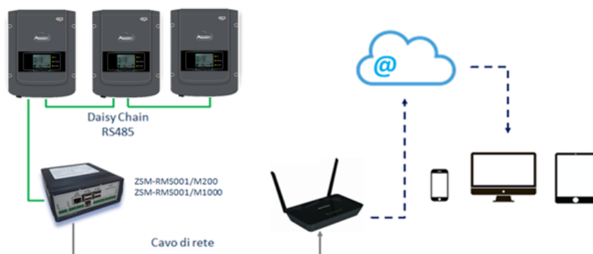
Figura 128 – Esquema de funcionamiento del Datalogger ZSM-RMS001/M200 / ZSM-RMS001/M1000
