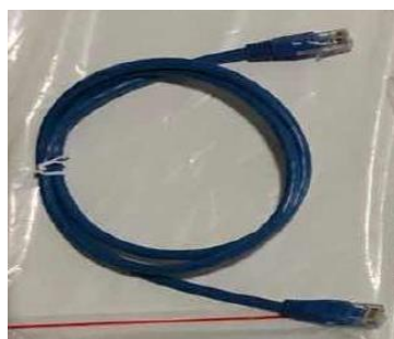
Figura 17 – Cable de comunicación entre baterías WeCo 4k4
