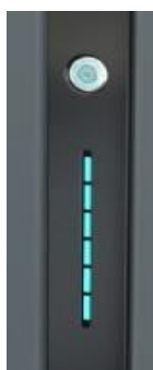
Figura 49- Botón de encendido de la batería AZZURRO 5000
