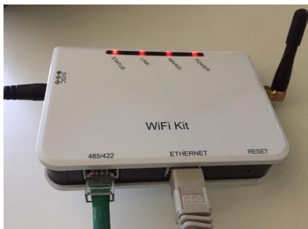
Figura 136 – Cable ethernet conectado al datalogger
