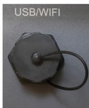
Figura 89 - Alojamiento de la tarjeta wifi externa
