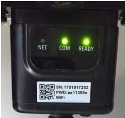
Figura 81 - Estado de comunicación irregular entre Wi-Fi y servidor remoto
