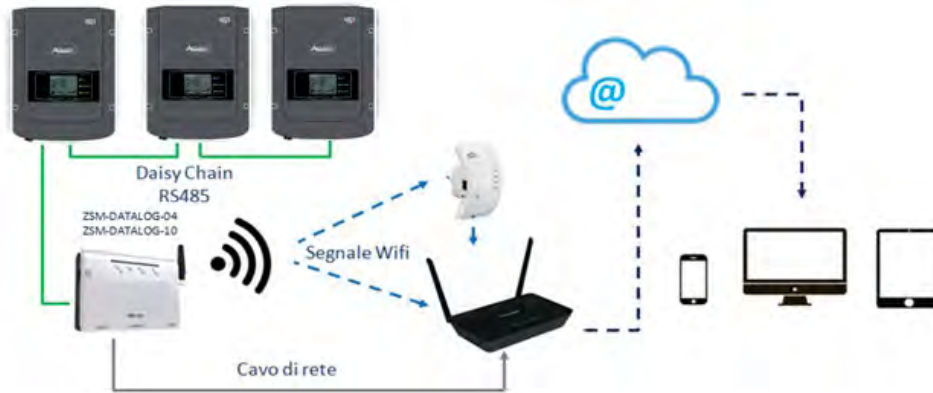
Figura 98 - Esquema para la conexión del datalogger ZSM-DATALOG-04 / ZSM-DATALOG-10
