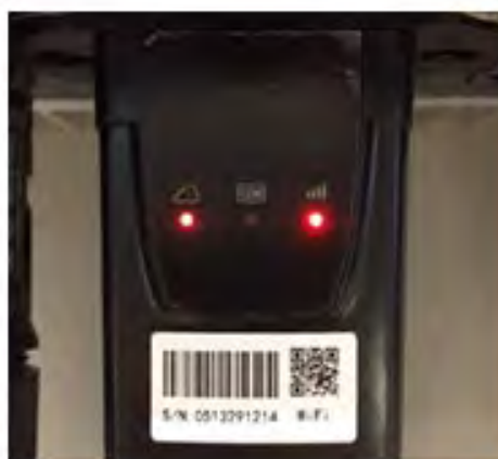
Figura 79 - Estado de comunicación irregular entre inversor y Wi-Fi
