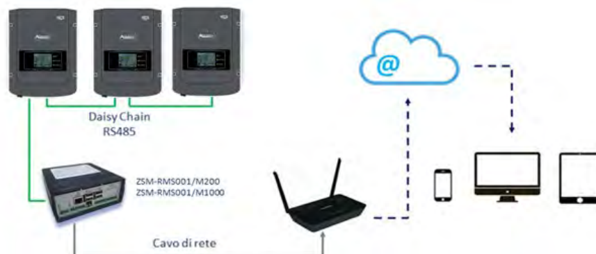
Figura 99 - Esquema que muestra el funcionamiento del datalogger ZSM-RMS001/M200 / ZSM-RMS001/M1000
