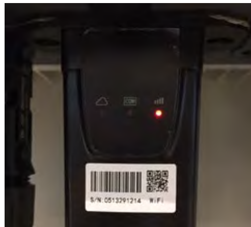
Figura 81 - Estado de comunicación irregular entre Wi-Fi y servidor remoto
