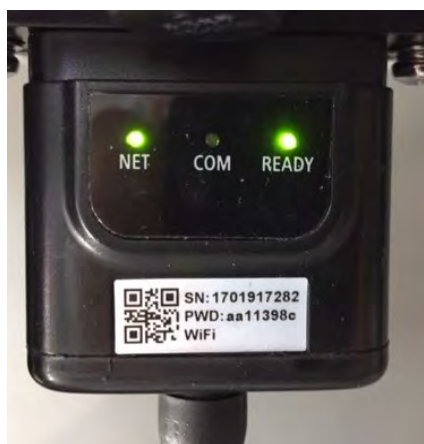
Figura 79 - Estado de comunicación irregular entre inversor y Wi-Fi
