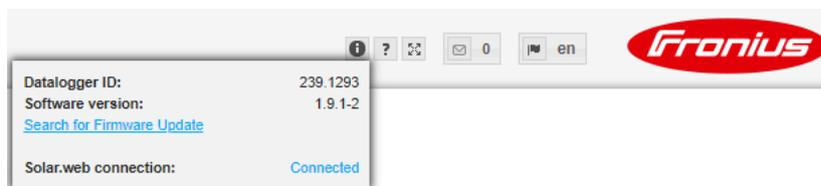
Quelle que soit la version du logiciel qui s'affiche dans l'interface Web, il est possible que plusieurs étapes de mise à jour soient nécessaires avant de pouvoir accéder à la dernière version du logiciel. Lors du processus de mise à jour, l'onduleur et la batterie peuvent être actualisés.
