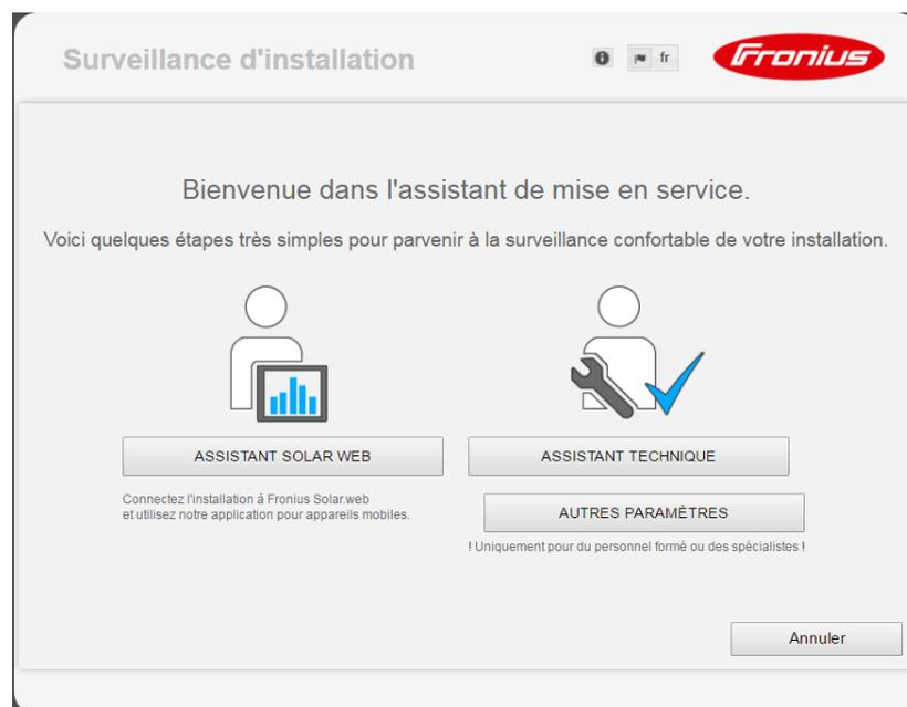
Si l'assistant technique est exécuté, le mot de passe de service doit absolument être noté. Ce mot de passe de service est nécessaire pour la configuration des points de menu Aperçu de l'installation, Éditeur de fournisseur d'électricité et Paramètres de batterie avancés. Si l'assistant technique n'est pas exécuté, aucune consigne n'est paramétrée pour la réduction de puissance et le mode hybride n'est pas activé (charge et décharge de la batterie).
