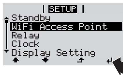
L'onduleur établit le point d'accès WLAN. Le point d'accès WLAN reste ouvert pendant 1 heure.
