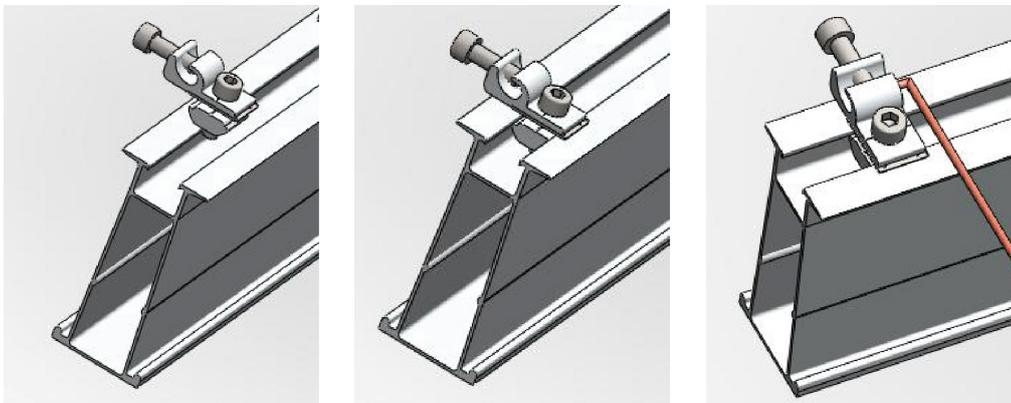
3. Siga el paso 2 para instalar el cable en el otro terminal de tierra.
