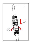
Asegúrese de alinear correctamente la posición de bloqueo del conector al insertarlo, de lo contrario podría haber riesgo para la seguridad personal. Después de alinear la posición de bloqueo, inserte completamente el conector y gire en sentido horario para apretar el hilo de conexión del conector en el lado del inversor, hasta que no haya espacios vacíos.
