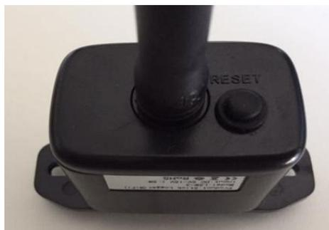
Figura 45 – Botón de Reset en el adaptador Wi-Fi
