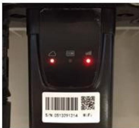
Figura 46 - Estado de comunicación irregular entre inversor y Wi-Fi
