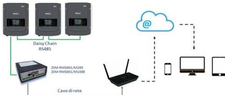
Figura 66 - Esquema que muestra el funcionamiento del datalogger ZSM-RMS001/M200 / ZSM-RMS001/M1000
