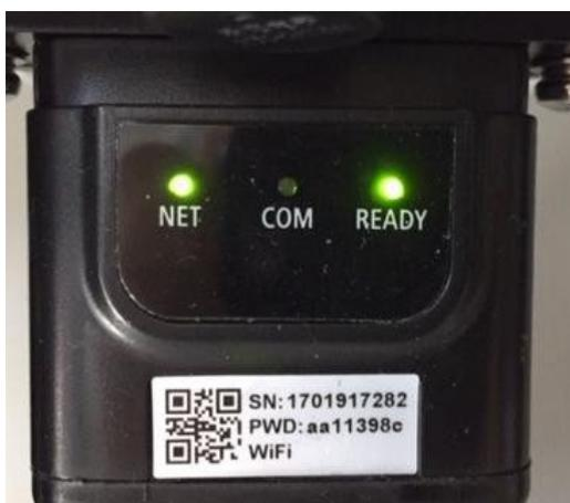
Figura 57 - Estado de comunicación irregular entre inversor y adaptador
