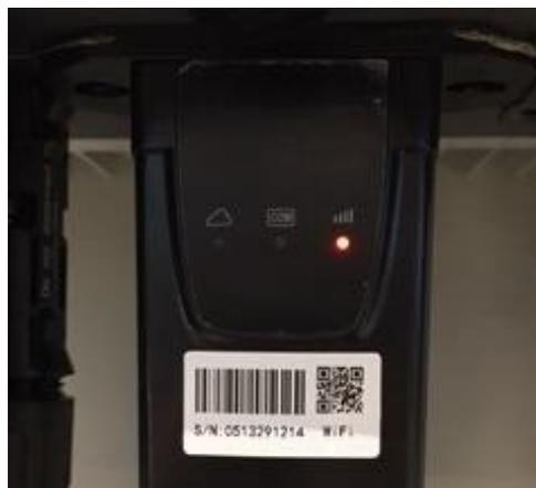
Figura 48- Estado de comunicación irregular entre Wi-Fi y servidor remoto
