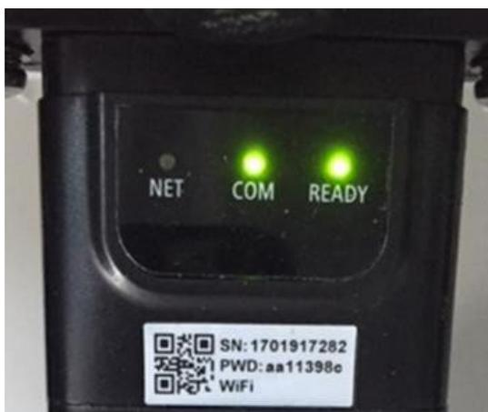
Figura 58- Estado de comunicación irregular entre adaptador y servidor remoto
