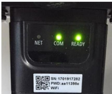
Figura 64- Estado de comunicación irregular entre adaptador y servidor remoto
