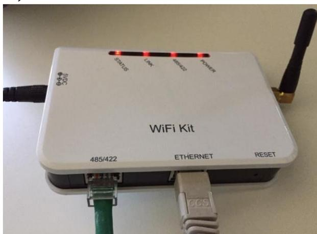
Figura 83- Cable Ethernet conectado al datalogger
