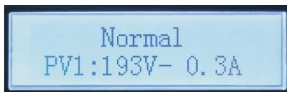
Estado operativo del inversor, potencia generada del fotovoltaico.
