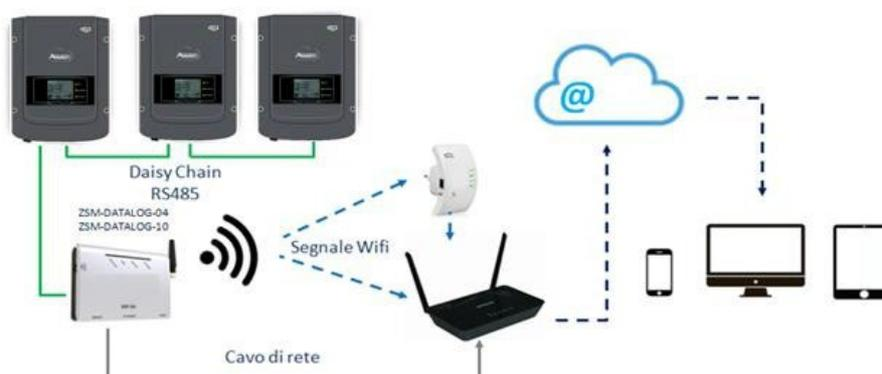
Figura 65 - Esquema de conexión del datalogger ZSM-DATALOG-04/ZSM-DATALOG-10
