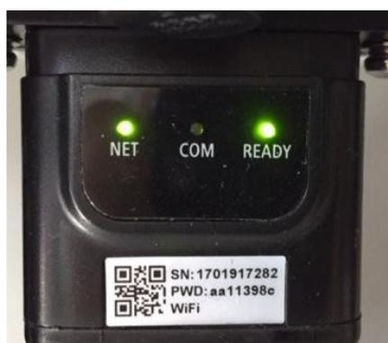
Figura 63 - Estado de comunicación irregular entre inversor y adaptador
