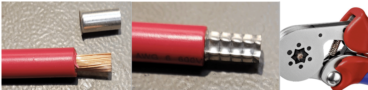
Puntera con crimpado hexagonal
