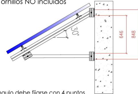
Cada triángulo debe fijarse con 4 puntos
