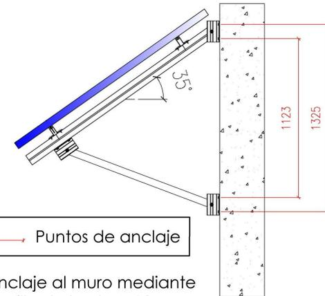
Anclaje al muro mediante tornillo de hasta M10
