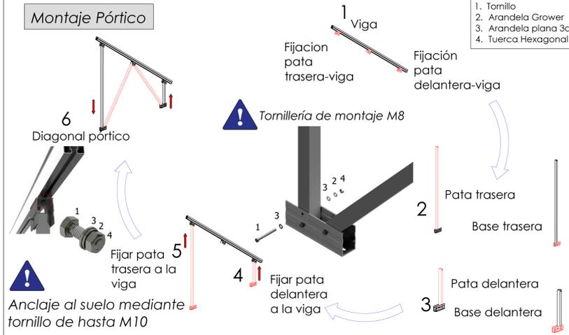
⚠ Anclaje al suelo mediante tornillo de hasta M10
