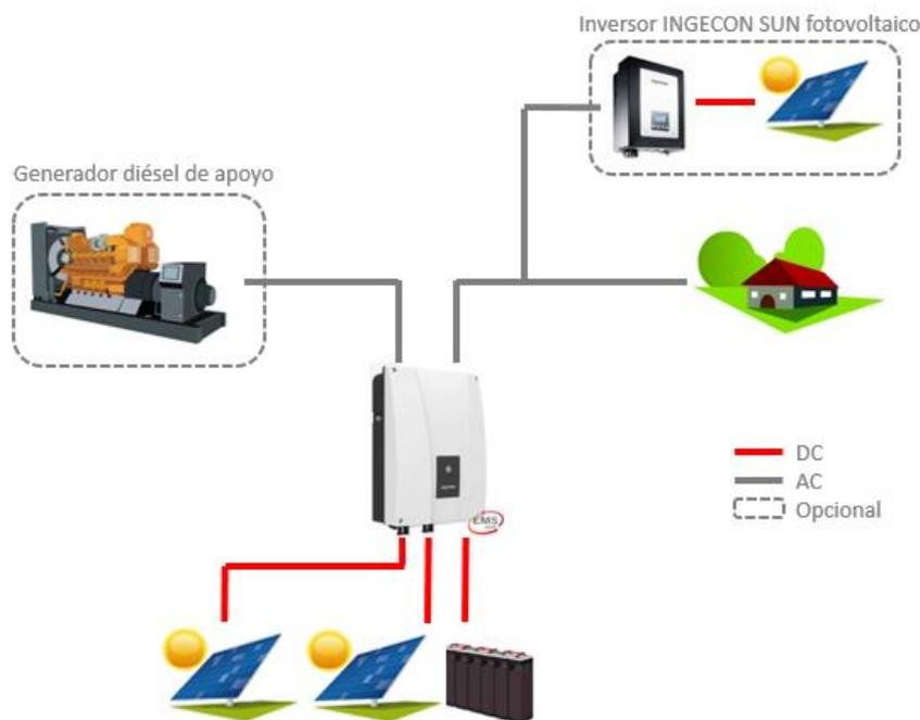
Figura 4: Instalación aislada
