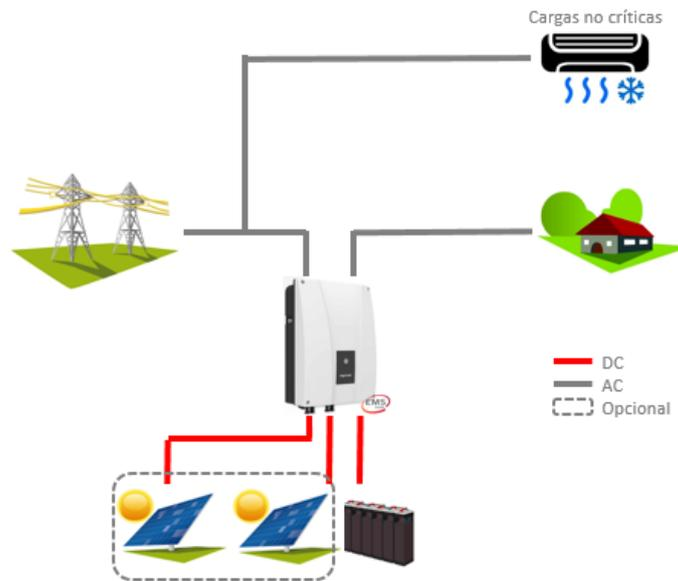
Figura 3: Instalación UPS
