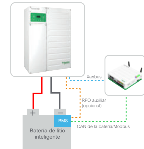
Batería de iones de litio con control de bucle cerrado
