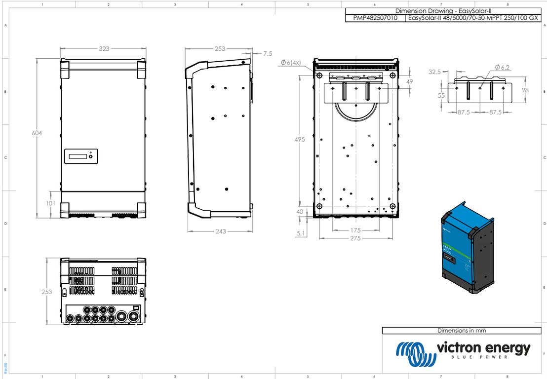
Esquema de dimensiones - EasySolar-II 48/5000/70-50 MPPT 250/100 GX - PMP482507010
