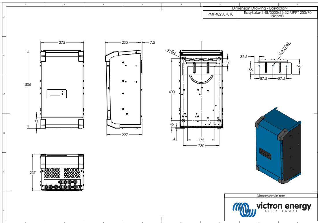
Esquema de dimensiones - EasySolar-II 48/3000/35-32 MPPT 250/70 GX - PMP482307010
