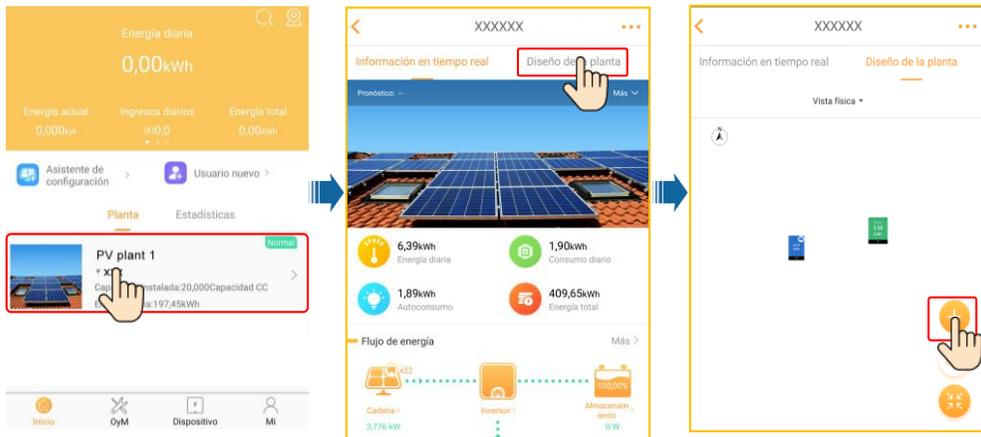
2. Inicie sesión en <https://intl.fusionsolar.huawei.com> para acceder a la interfaz de usuario web del sistema de gestión inteligente de celdas fotovoltaicas FusionSolar. En la **Página de inicio**, haga clic en el nombre de la planta para acceder a la página de la planta. Seleccione **Diseño de la planta**. Seleccione **+** > **Generar con IA**, y cree una distribución física como se indica. También puede crear una distribución de ubicación física manualmente.
