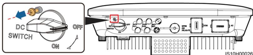
4. Si entre la cadena fotovoltaica y el inversor solar hay un interruptor de CC, enciéndalo.
