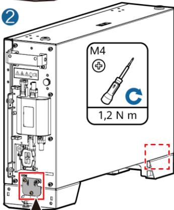
2 Instale las piezas de conexión en ambos lados y ajuste los cuatro tornillos.
