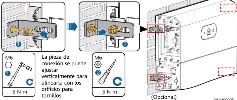
3. (Opcional) Asegure los módulos de expansión de la batería a la pared según las instrucciones en el paso 2.
