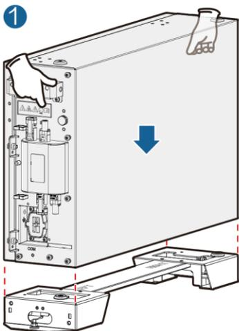
1 Alinee el primer módulo de expansión de la batería con el soporte de instalación sobre suelo.
