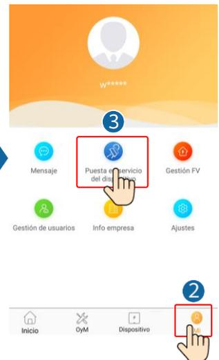
2. Conéctese a la red WLAN del inversor solar e inicie sesión como **installer** para acceder a la pantalla de puesta en servicio del dispositivo.
