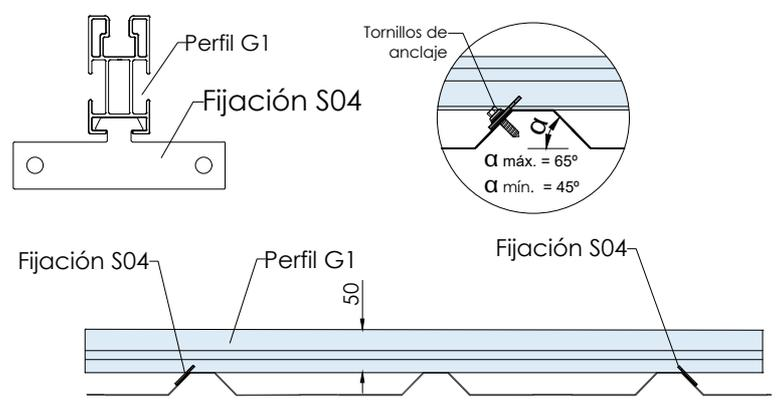
Solo una fijación por greca. Las fijaciones de la parte izquierda del perfil, se ubican en el lado izquierdo de la greca hasta llegar al punto medio, a partir de aquí, a la derecha de la greca.
