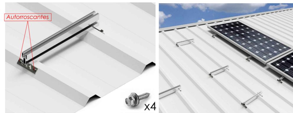
El perfil se fija a la chapa mediante 2 fijaciones y 4 tornillos autorroscantes.
