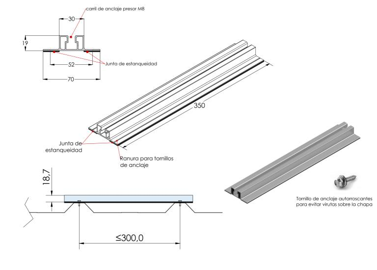
Fijación para todo tipo de cubiertas metálicas, distancia máxima entre grecas ≤300. Anclaje sobre la greca.
