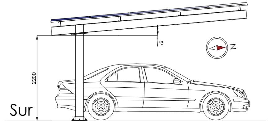
Se requiere cimentación previa a la instalación de la marquesina. Tornillería de anclaje a suelo no incluida.
