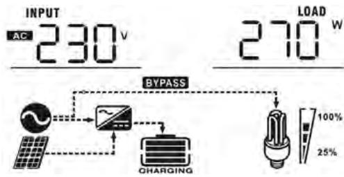
Si la carga es mayor a 1kW ( $\geq 1\text{kVA}$ ), la carga en W aparecerá como 1.2kW
