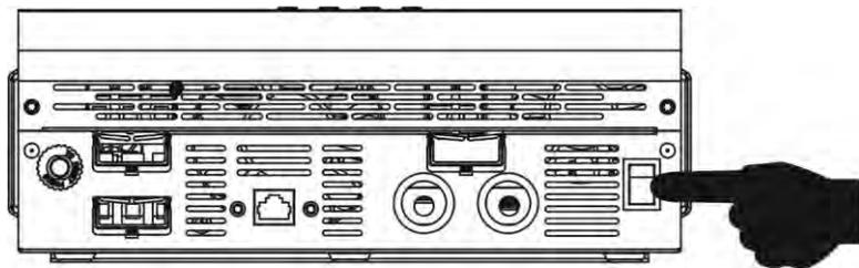
Una vez que el dispositivo esté correctamente instalado, coloque el interruptor de encendido y apagado en posición ON. (Se encuentra en la parte posterior inferior del equipo)
