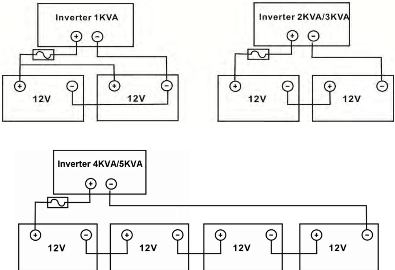
**NOTA:** Utilice solo baterías de plomo ácido libres de mantenimiento o de GEL.
