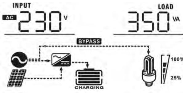
Si la carga es mayor a 1kVA ( $\geq 1\text{kVA}$ ), la carga en VA aparecerá como 1,5 KVA
