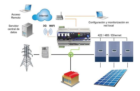
Se comunica con los inversores de los principales fabricantes, limitando su producción en caso necesario para asegurar la inyección cero en la red.
