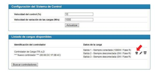
Mediante el primero de los iconos se deberá definir la configuración de red del controlador de carga.
