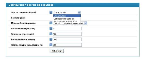
Hay disponibles dos opciones de control del relé: mediante una de las salidas del conector de control de cargas, situado en la parte superior del ITR o mediante un dispositivo remoto controlado mediante protocolo MODBUS TCP.
