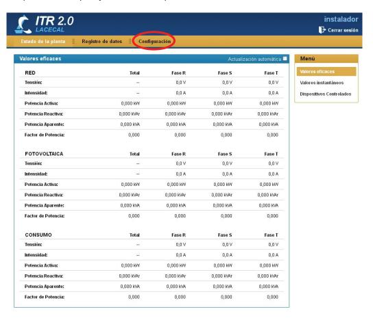
La primera vez que acceda al menú de 'Configuración' debe hacerlo mediante la contraseña genérica de usuario (ITR1234). Mediante esta contraseña únicamente se pueden configurar las opciones de conectividad del ITR 2.0.
