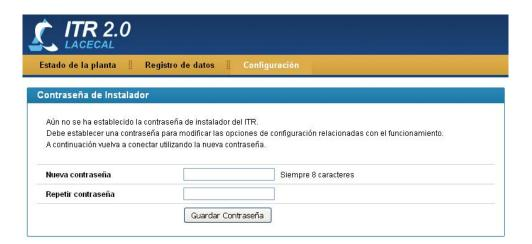
Mediante su contraseña de instalador podrá establecer los datos de configuración y funcionamiento de la planta y los inversores. En las distintas pantallas de configuración puede situar el ratón sobre el icono azul de información para obtener ayuda de la opción correspondiente.
