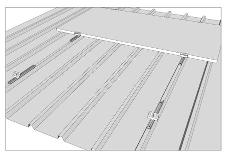
El microperfil TS-D1 permite la fijación de los paneles solares en cubiertas metálicas de chapa grecada y sandwich de 5 grecas (grosor mínimo 0,5mm), atornillando el mismo a la zona superior de las grecas mediante tornillería autoroscante con arandela de sellado (no incluida).
