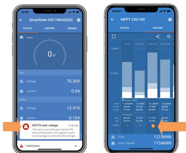
VictronConnect: captura de pantalla de un error nº 33 y de un historial indicando un error
