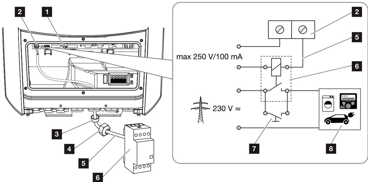
Fig. 63: Conexión eléctrica del autoconsumo
