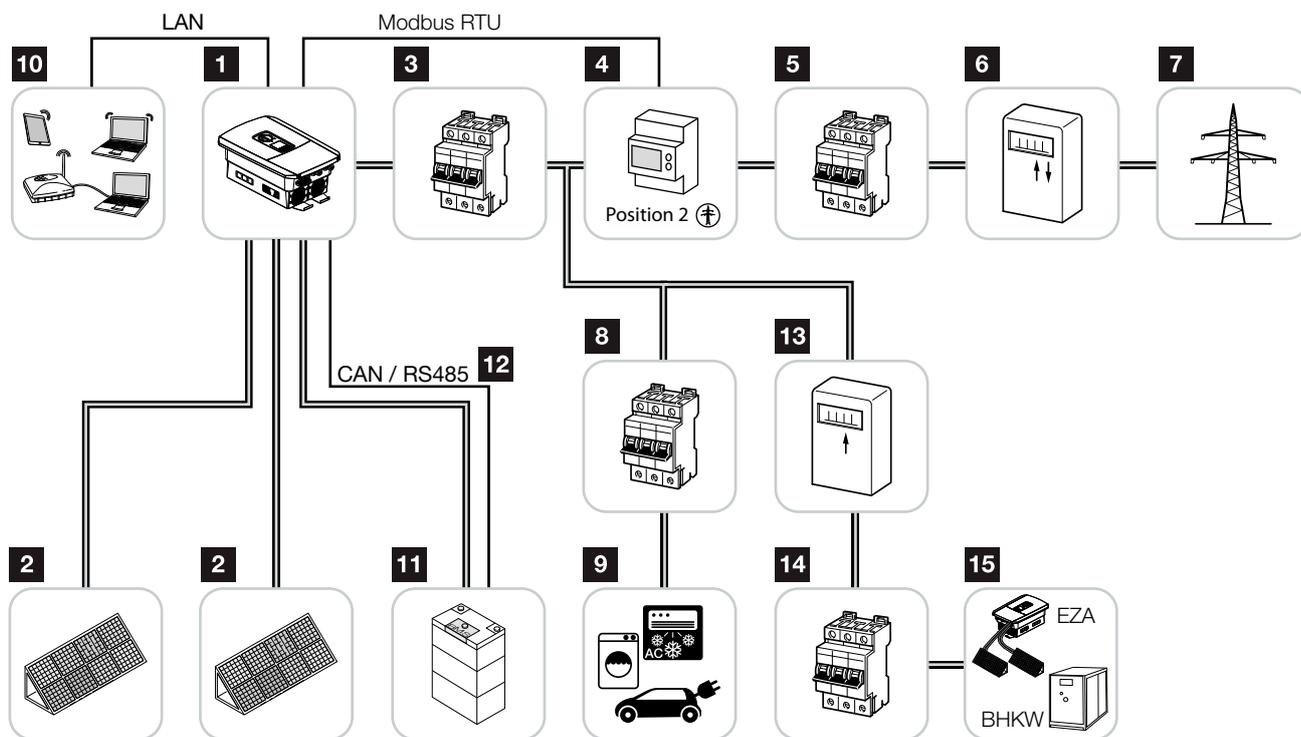
Fig. 9: Instalación fotovoltaica con proveedor de energía CA
