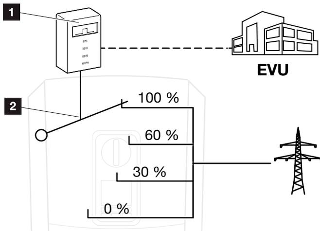
Fig. 59: Control de la potencia activa con receptor de telemando centralizado
