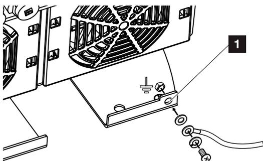
Fig. 25: Conexión PE específica del país exterior
