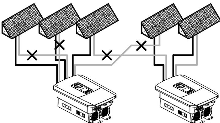
Fig. 39: Conexión incorrecta de generadores fotovoltaicos
