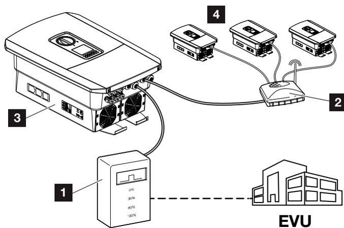
Fig. 60: Inversor con receptor de telemando centralizado
