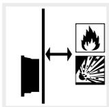
Garantizar una distancia de seguridad suficiente con los materiales inflamables y espacios en los que exista peligro de explosión en el entorno.
