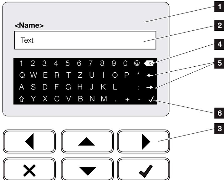
Fig. 44: Manejo de la pantalla mediante el teclado
