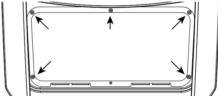
Fig. 22: Retirar la tapa del área de conexión
