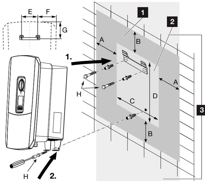
Fig. 18: Montaje en pared mediante soporte mural
