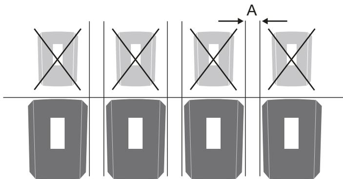
Fig. 19: Montaje en pared de varios inversores
