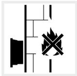
Montar el inversor en una superficie de montaje no inflamable.
