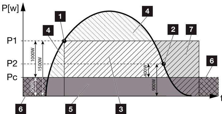
Fig. 68: Curva del autoconsumo dinámico (función 2)
