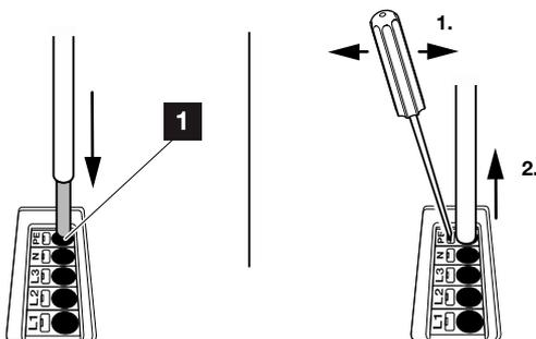
Fig. 24: Regleta de bornes con mecanismo de resorte
