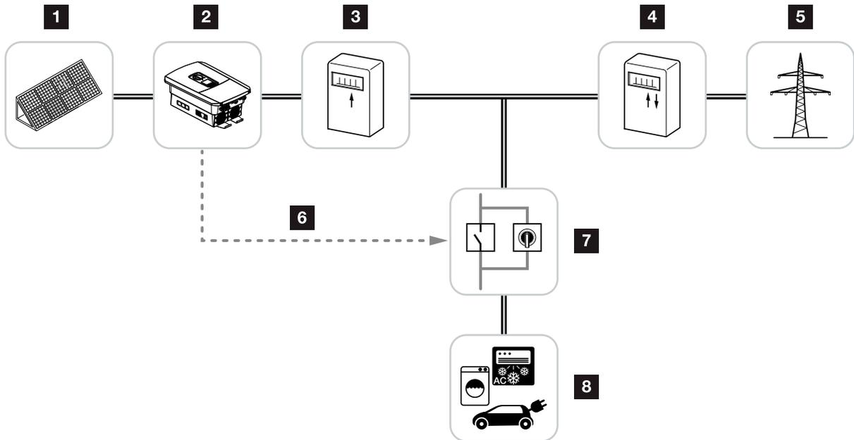
Fig. 62: Configuración del autoconsumo
