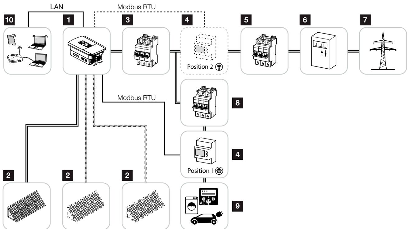
Fig. 7: Instalación fotovoltaica con 3 entradas FV
