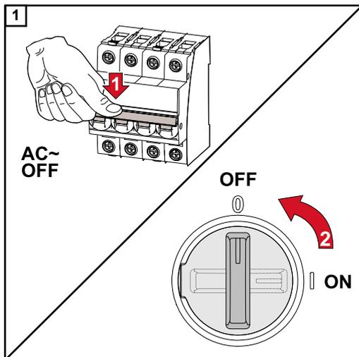
Desconectar el disyuntor y el seccionador CC.
