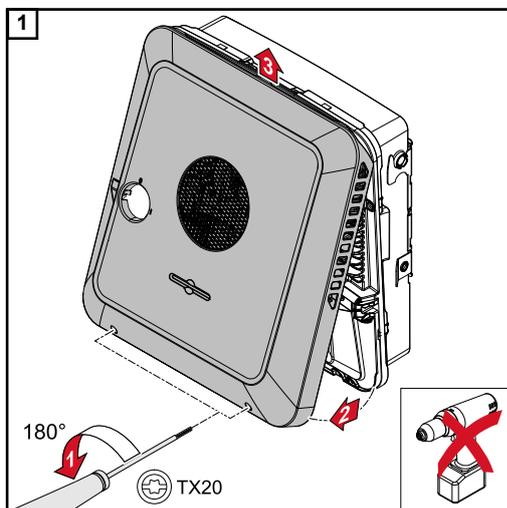
Aflojar los 2 tornillos de la parte inferior de la cubierta de la carcasa con un destornillador (TX20) y girar 180° a la izquierda. Luego, levantar la tapa de la carcasa en la parte inferior del inversor y desengancharla hacia arriba.
