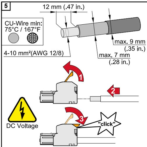
Elegir la sección transversal del cable de acuerdo con las especificaciones de **Cables admisibles** a partir de la página 62. Retirar 12 mm de aislamiento de los conductores individuales. Abrir la palanca de accionamiento del borne de conexión levantándola e introducir el conductor individual pelado en el puesto designado del borne de conexión hasta el tope. Luego, cerrar la palanca de funcionamiento hasta que se enclave.
