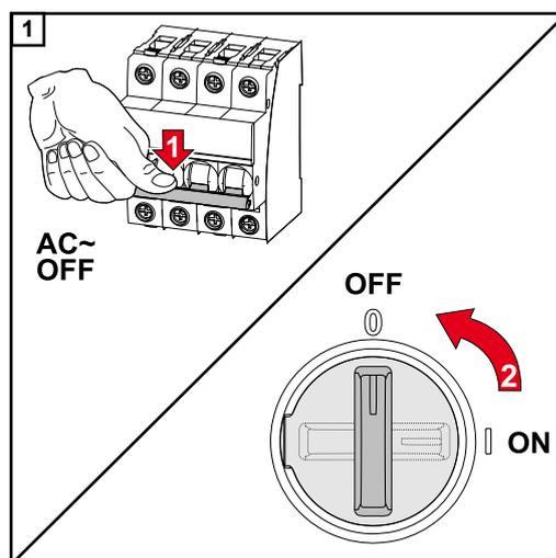
Desconectar el disyuntor automático. Poner el interruptor del seccionador CC en "OFF".
