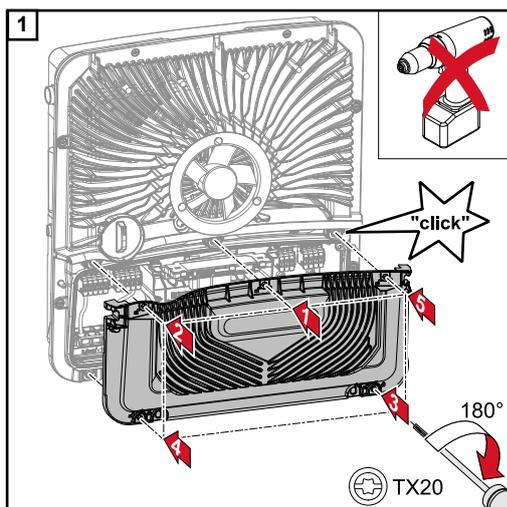
Colocar la cubierta en la zona de conexión. Apretar los 5 tornillos en el orden especificado con un destornillador (TX20) y un giro de 180° a la derecha.
