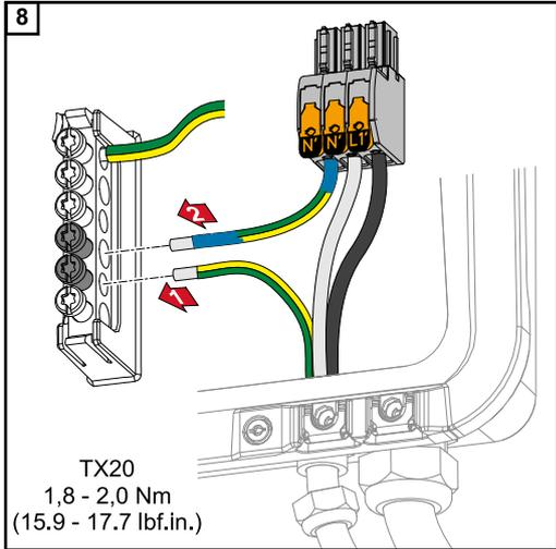
Fijar el conductor protector y el conductor PEN al borne de electrodo de tierra con un destornillador (TX20) y un par de apriete de 1,8 - 2 Nm.
