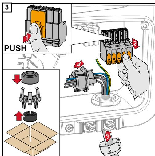
Presionar el bloqueo de la parte trasera del borne de conexión y tirar del borne de conexión CA.
