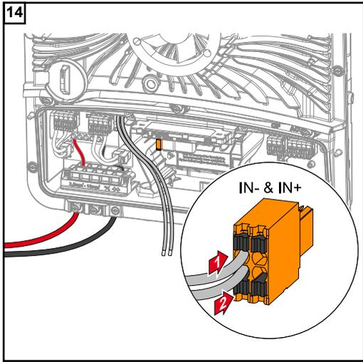
Conectar el cable de señal al borne de conexión Push-In WSD en los puestos IN- e IN+ según las indicaciones del etiquetado.
