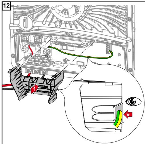
Insertar de nuevo la separación de la zona de conexión.
