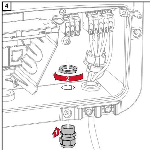
Insertar la descarga de tracción en el orificio y sujetarla con el par de torsión especificado por el fabricante.
