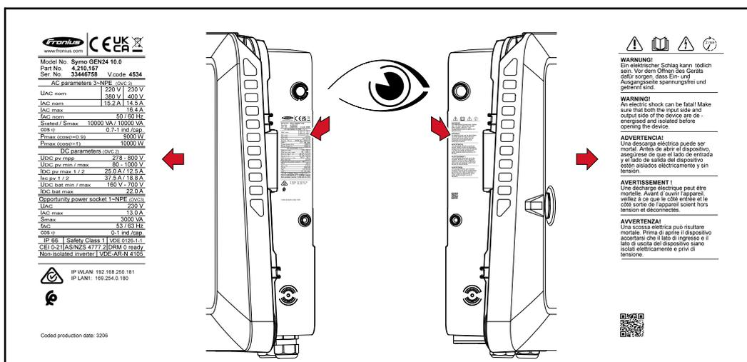
En la parte inferior de la placa de características hay un número de 4 dígitos (coded production date), a partir del cual se puede calcular la fecha de fabricación.
