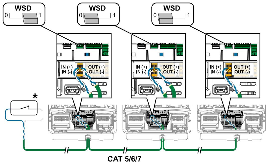
\* Contacto libre de potencial del dispositivo de activación (p. ej. protección central NA). Si se utilizan varios contactos libres de potencial en una cadena WSD, deben conectarse en serie.
