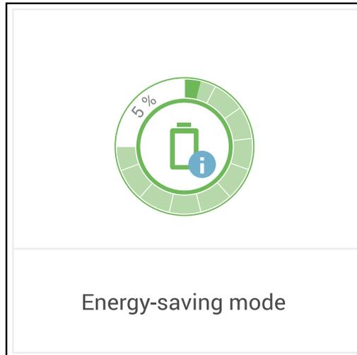
El modo de ahorro de energía se indica en la página web del inversor y en Solar.web mediante una "i" al lado del símbolo de batería en la vista general de la instalación.
