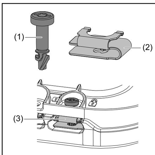
Para el montaje de la tapa de la zona de conexión y de la tapa frontal se utiliza un sistema de cierre rápido (3). El sistema se abre y se cierra con media vuelta (180°) del tornillo con bloqueo cautivo (1) en el muelle de liberación rápida (2).
