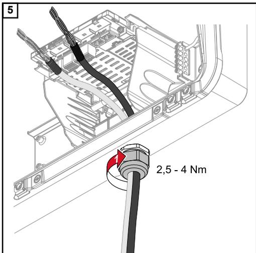
Fijar el racor de la descarga de tracción con un par de 2,5 - 4 Nm como máximo.
