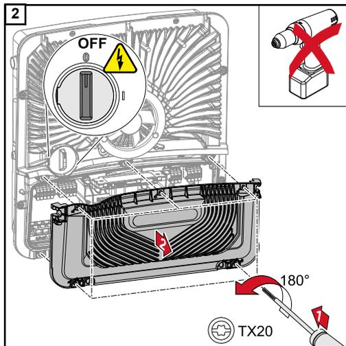
Asegurarse de que el seccionador CC se encuentra en la posición de interruptor "Desconectado".
