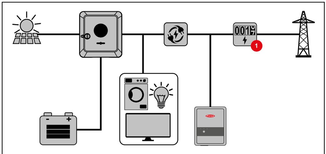
**Modo de operación: Inversor con batería y otros inversores**
