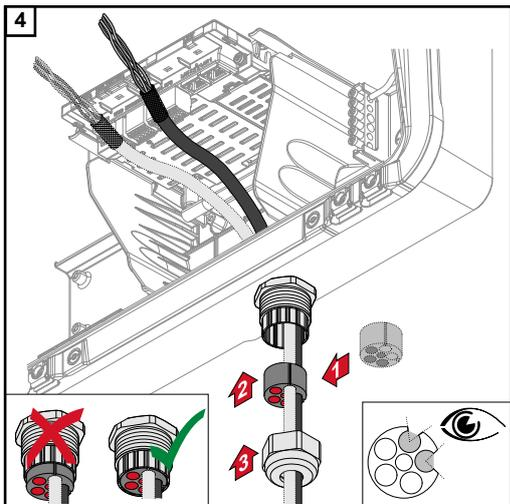
Introducir el anillo de junta entre el racor y la abertura del chasis. Introducir a presión los cables de datos en el portacables de la junta. Luego, presionar la junta hasta el borde inferior de la descarga de tracción.
