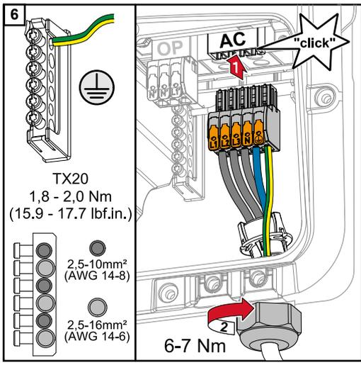
Encajar y enclavar el borne de conexión CA en el puesto de CA. Fijar la tuerca de sombrerete de la descarga de tracción con un par de 6-7 Nm.
