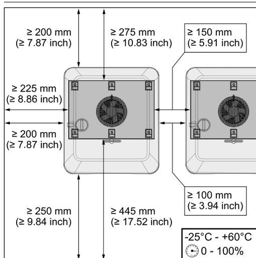
Realizar la instalación solo sobre una base firme y que no sea inflamable.
