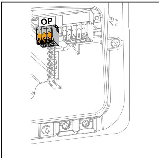
El PV Point puede utilizarse para alimentar dispositivos eléctricos monofásicos hasta una potencia máxima de 3 kW en el borne de conexión Opportunity Power (OP) en caso de fallo de la red pública, siempre que se disponga de suficiente energía de los módulos solares o de una batería opcional. No hay tensión en el borne de conexión OP en el modo de conexión a red, por lo que las cargas conectadas no se suministran en este modo.
