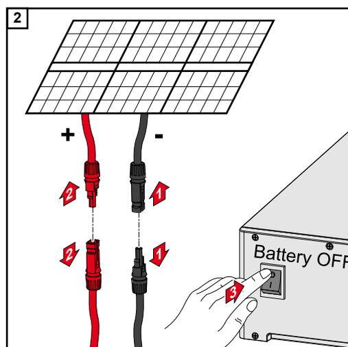
Desconectar las uniones de las series de módulos fotovoltaicos (+/-). Desconectar la batería conectada al inversor.
