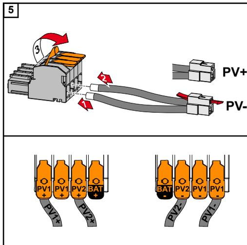
Conectar los cables PV+/PV- suministrados a las conexiones respectivas.
