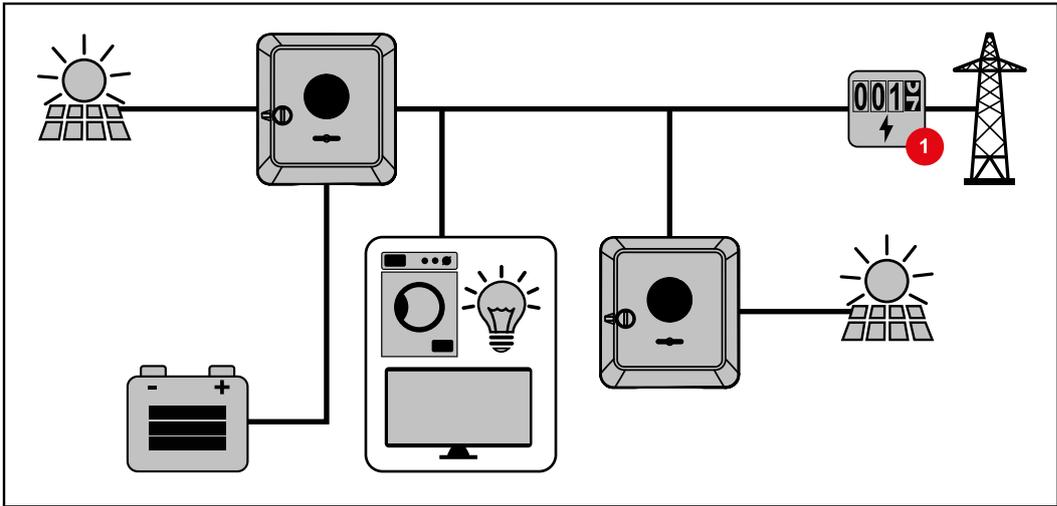
**Modo de operación: Inversor con batería, otro inversor y función de emergencia**
