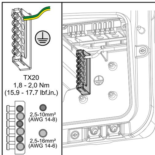
El borne del electrodo de tierra ⊕ permite conectar a tierra otros componentes como, por ejemplo:
