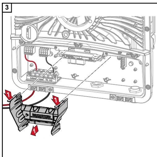
Eliminar la separación de la zona de conexión accionando los ganchos Snap.
