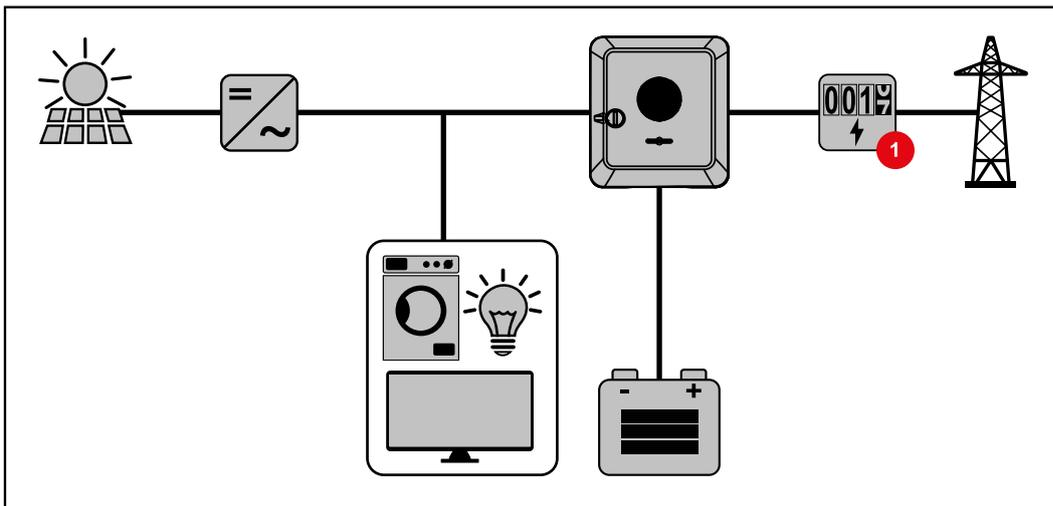
**Modo de operación - Inversor con batería y función de corriente de emergencia**
