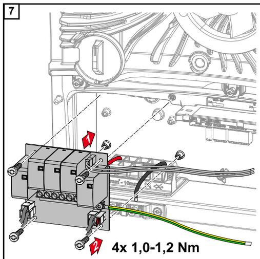
Insertar el circuito impreso en el inversor y fijarlo con los 4 tornillos (TX20) suministrados y un par de 1,0 - 1,2 Nm.
