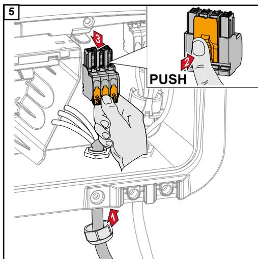
Pasar el cable de red a través de la descarga de tracción desde abajo. Desconectar el borne de conexión OP.
