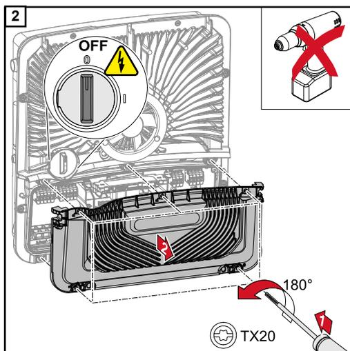
Aflojar los 5 tornillos de la cubierta de la zona de conexión con un destornillador (TX20) y girar 180° a la izquierda. Retirar la cubierta de la zona de conexión del dispositivo.
