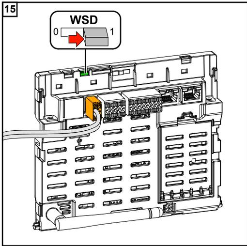
Comprobar si el interruptor WSD está en la posición 1 y cambiar en caso necesario (ajuste de fábrica: posición 1).
