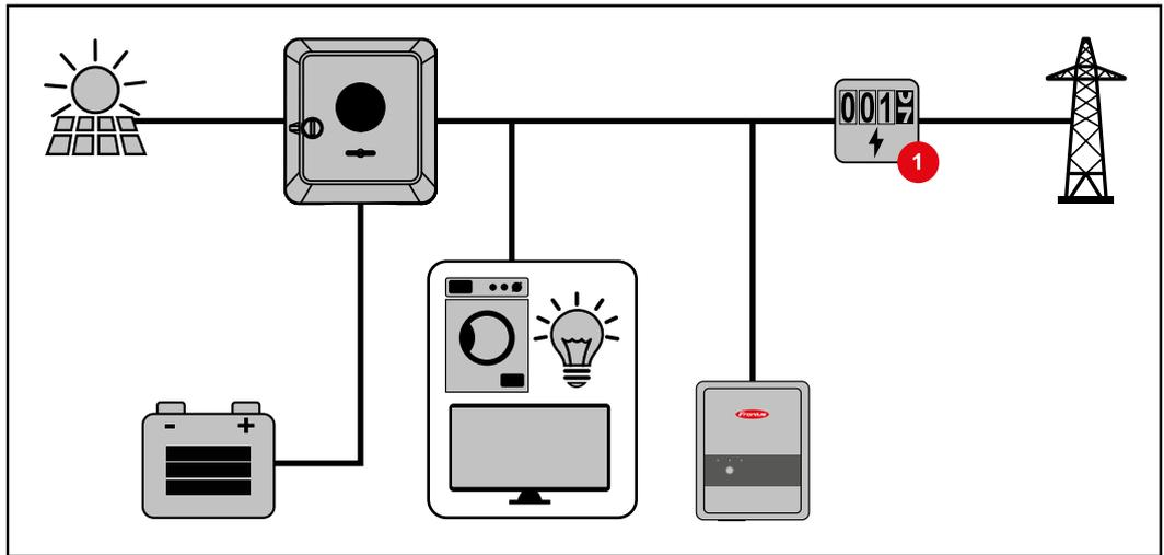
**Modo de operación - Inversor con batería, Ohmpilot y función de emergencia**
