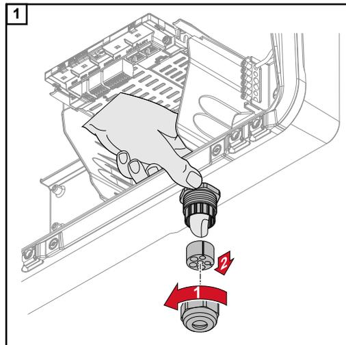
Alojar el racor de la descarga de tracción y presionar el anillo de junta con los tapones ciegos desde el interior del dispositivo.
