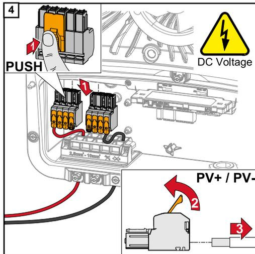
Retirar los bornes Push-In de CC de los puestos y desconectar el cable (solo es necesario si la instalación ya existe).
