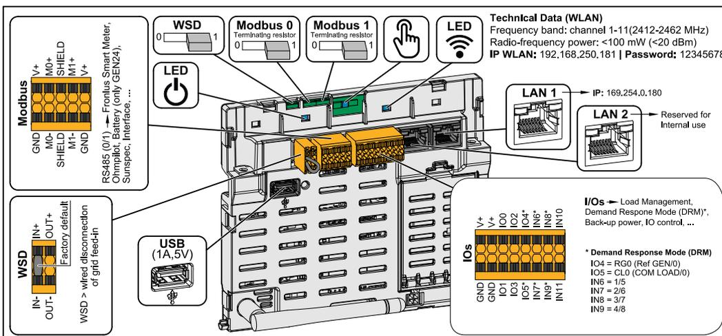
Borne de conexión Push-In para la instalación de Modbus 0, Modbus 1, 12 V y GND (Ground).
