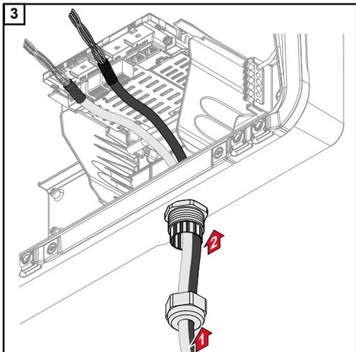
Primero, pasar los cables de datos por el racor de la descarga de tracción y, a continuación, por la abertura del chasis.
