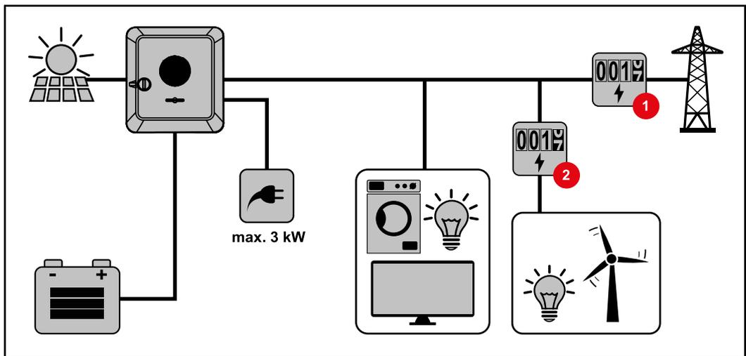
**Modo de operación: inversor con batería, acoplado (CA) a otro inversor**
