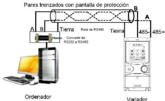
Figura 7-1 Esquema de conexión RS485 para una red con un único variador
