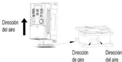
Figura 6-1 Instalación del ventilador de los variadores 1PH, 230V,  $\leq 2,2\text{kW}$
